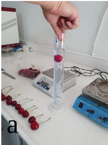
Şekil 3.4 a) Meyve hacmi ölçümü b) Meyvenin dar eni, geniş eni ve boyunun ölçümü
