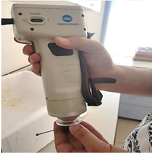
Şekil 3.5 a) Konica Minolta Colorimeter-CR 400 cihazı ile renk ölçümü b) Kirazın renk değerlerinin ölçümünde kullanılan parametreler (Anonim, 2022h)
