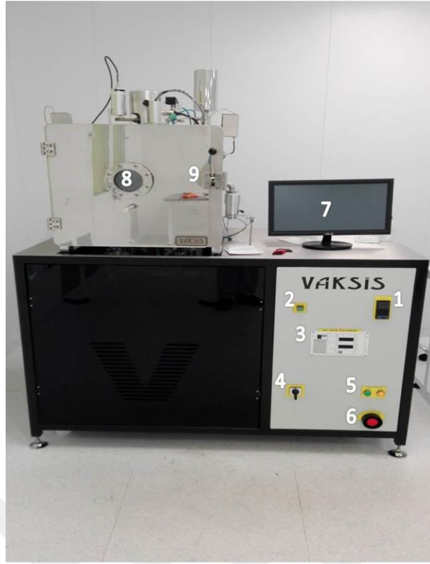
Şekil 17. Vaksis Saçtırma sistemi. 1. Altlık ısıtıcı PID kontrolcüsü 2. Bilgisayar açma/kapama butonu 3. DC güç kaynağı 4. Ana şalter 5. Başlatma durdurma butonları 6. Acil durdurma butonu 7. Kontrol ünitesinin monitörü 8. Plazma izleme penceresi 9. Kaplama odası.
