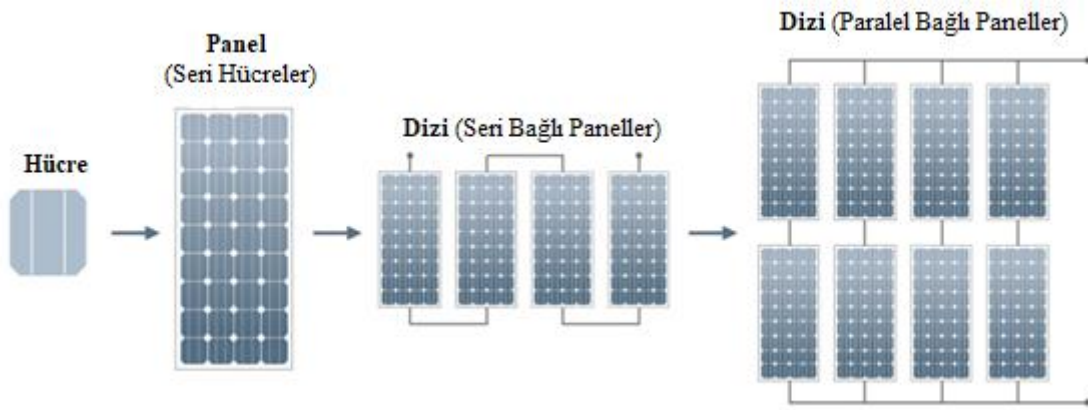
Şekil 2.20. FV hücre, panel ve diziler (Birkeland, 2018)
