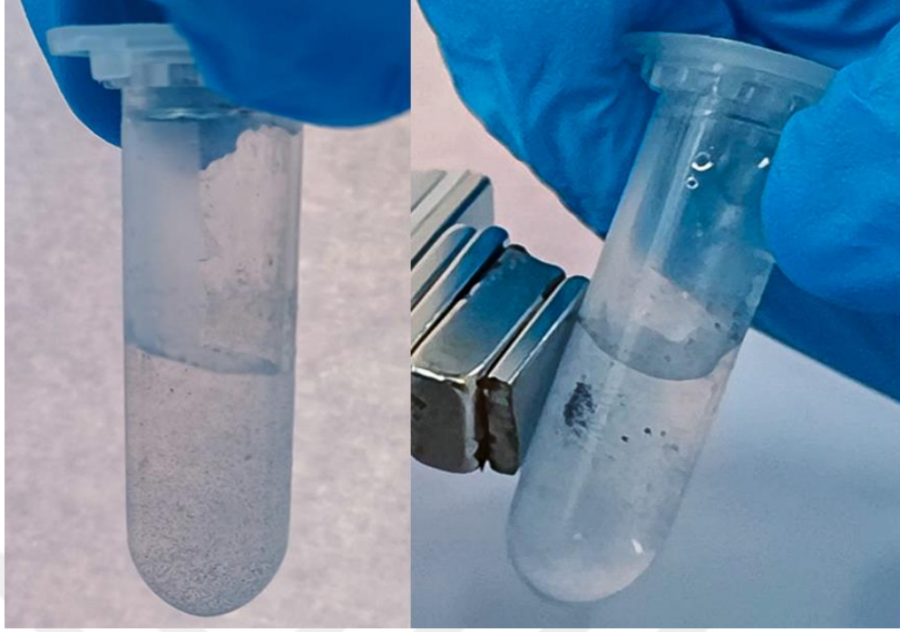
Resim 3. PPy-COOH/Ni manyetik mikromotorların mıknatıs ile ayrılması.
