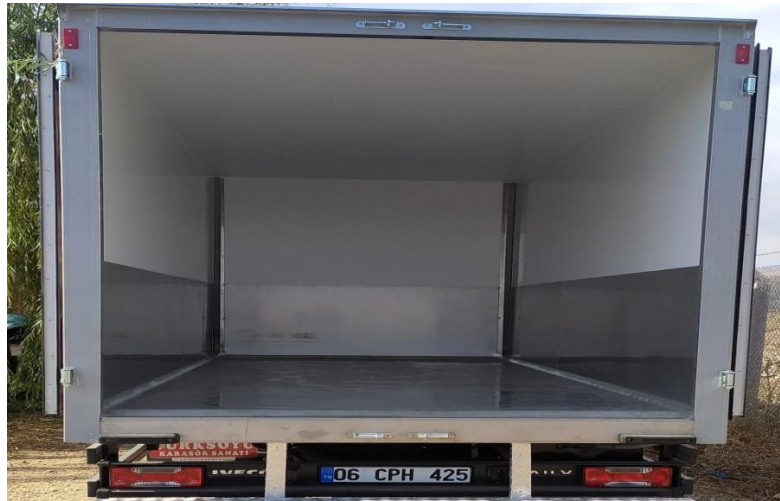
Şekil 15. Lisanslı Tıbbi Atık Taşıma Aracının İç Görşeli
