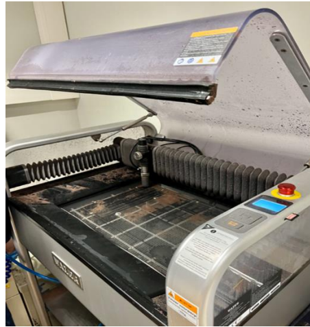
Şekil 3.7 Wazer® - Su jeti kesim işlemi
