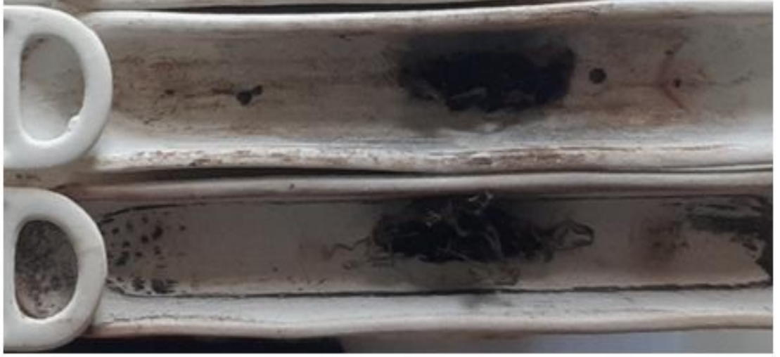
Şekil 3.8. PKS polimeri ile kaplı PAN liflerinin 1000 °C sıcaklıkta Ar gazı atmosferinde fırınlanması sonrası (SXPKS) dijital fotoğrafları
