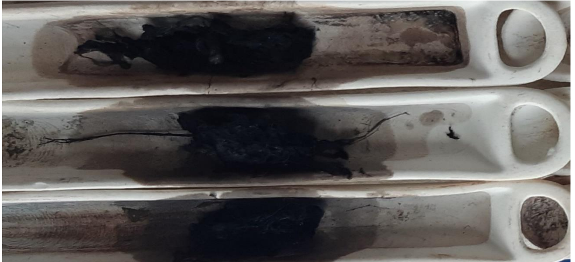
Şekil 3.7. PKS polimeri ile kaplı PAN liflerinin 270 °C fırınlanması sonrası (XPKS) dijital fotoğrafları
