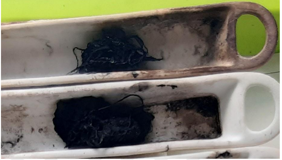
Şekil 3.10. PMSi polimeri ile kaplı PAN liflerinin 270 °C fırınlanması sonrası (XPM) dijital fotoğrafları
