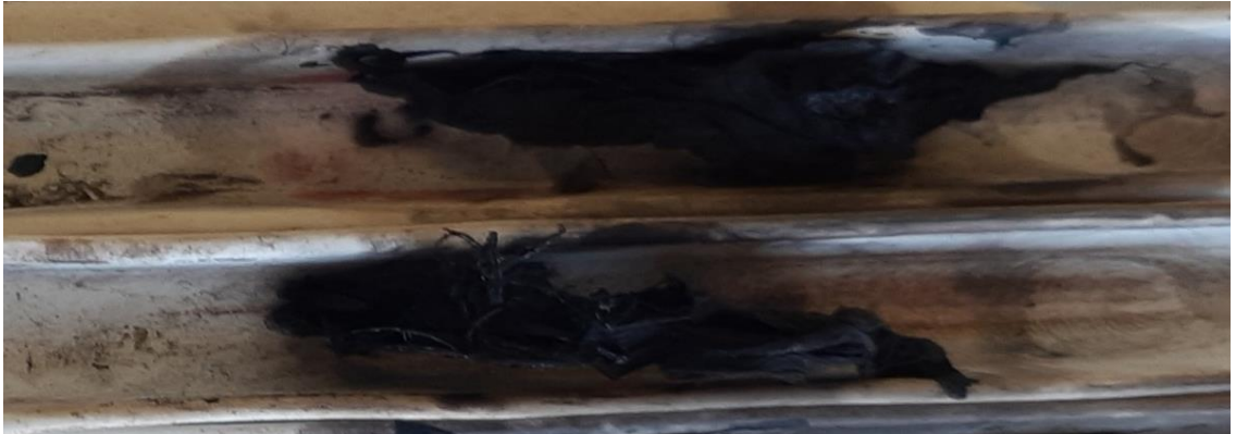
Şekil 3.5. PAN liflerinin 1000 °C Ar gazı atmosferinde fırınlanması sonrası (SXPAN) dijital fotoğrafları
