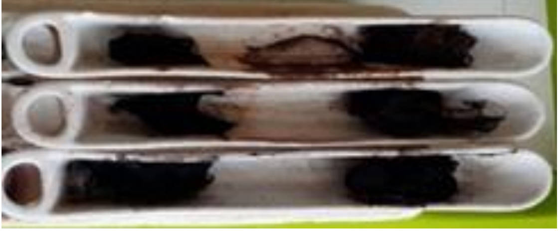
Şekil 3.4. PAN liflerinin 270 °C fırınlanması sonrası (XPAN) dijital fotoğrafları
