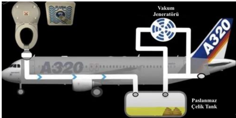
Şekil 17: Uçak İçi Islak Hacim Sistem Şeması Görseli (URL-62).
