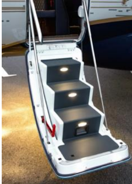
Şekil 46: Embraer Phenom 300E Merdivenli Kapı ve Basamak Aydınlatması (URL-31).
