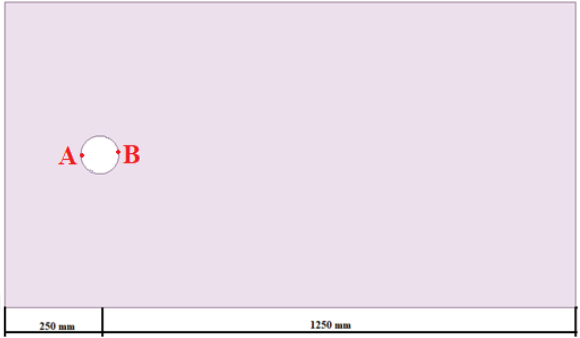
Şekil 3.45. Referans geometri üzerinde y^+ değerinin hesaplandığı bölgenin şematik gösterimi
