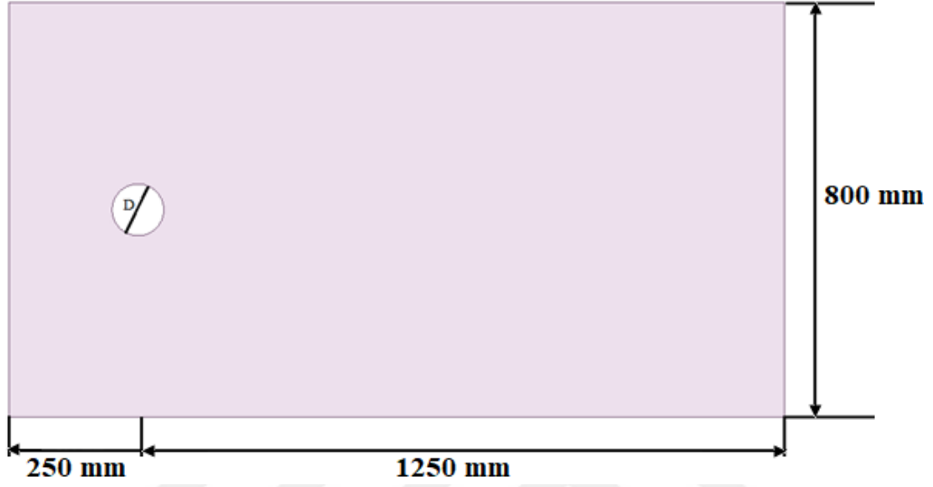
Şekil 3.13. Kondjoyan ve Daudin (1995) referans geometrisi
