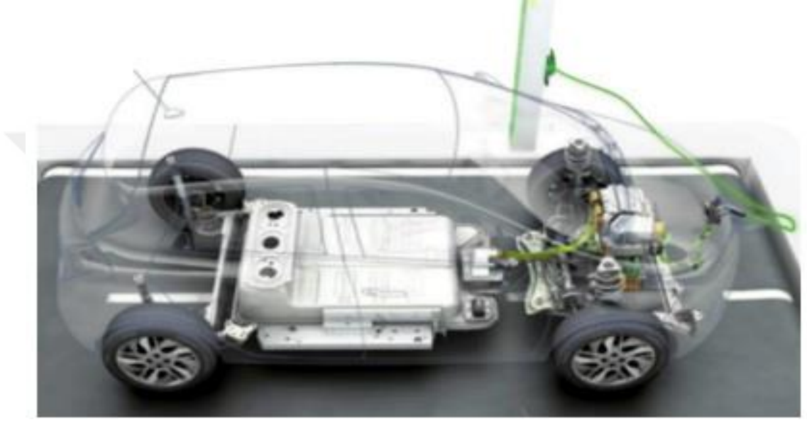
Şekil 2.31. Tümü-EA'ya örnek iç yapı (UKIP 2014)
