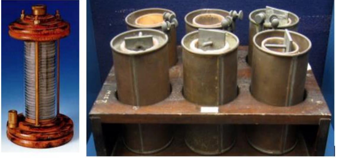
Şekil 2.20. a) Volta b) Daniell Pili
