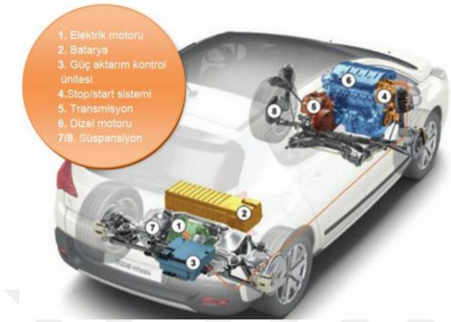
Şekil 2.33. Örnek HEA iç yapısı
