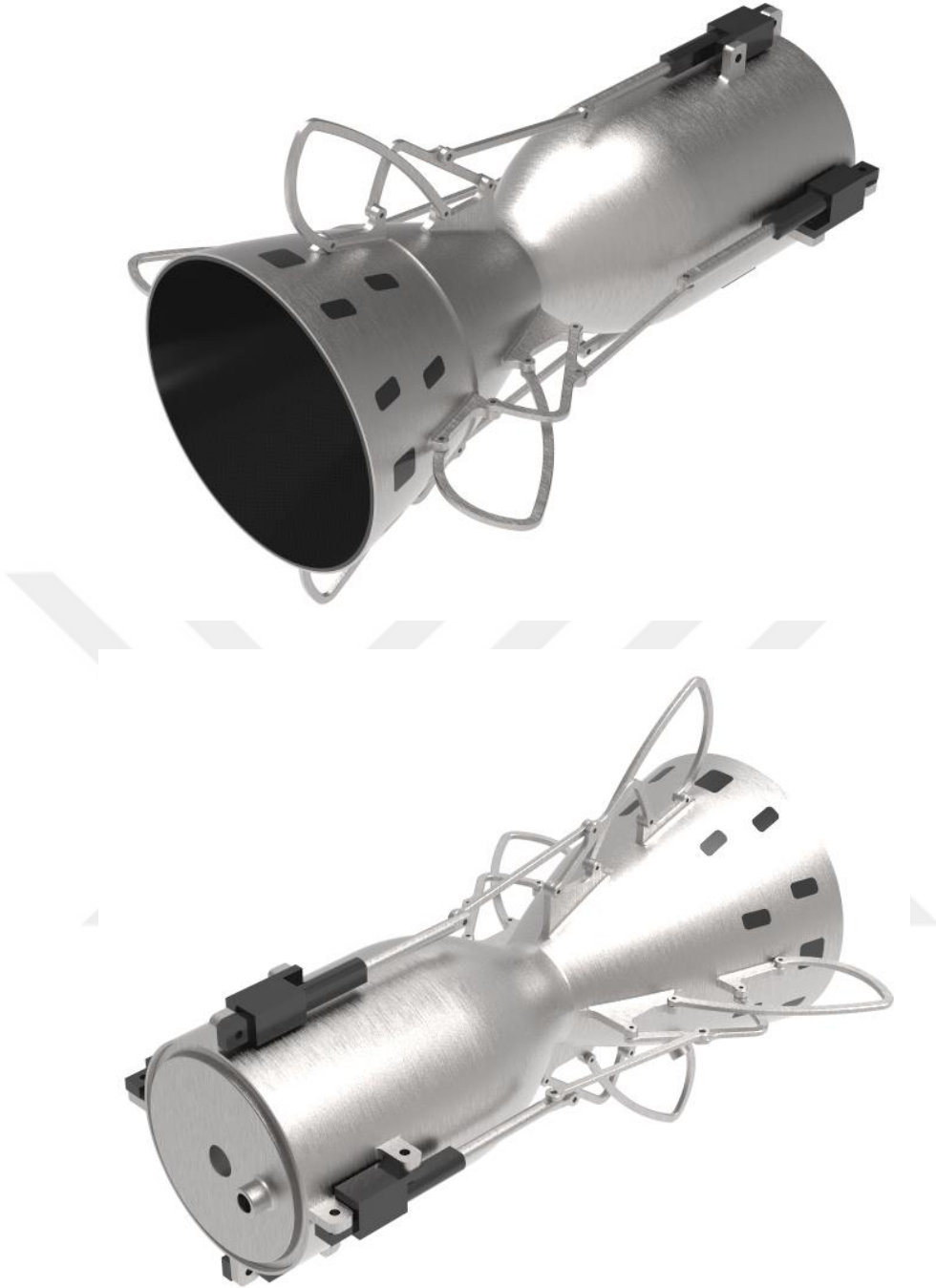
Şekil 5.16. Uzatılabilir difüzörlü roket motorunun difüzörünün tamamen açılmış hali.
