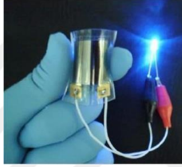
Şekil 1.2. Bükülebilir lityum iyon pil [4].
