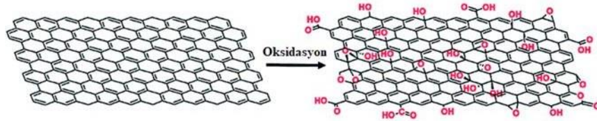
Şekil 2.3. Grafen oksit oluşturmak için grafen tabakasının oksidasyonu [26].
