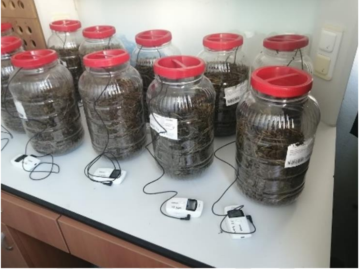
Şekil 4. Aerobik stabilite sürecinde silo içi sıcaklık ve dış sıcaklıkların datalogger aracılığı ile kayıt edilmesi
