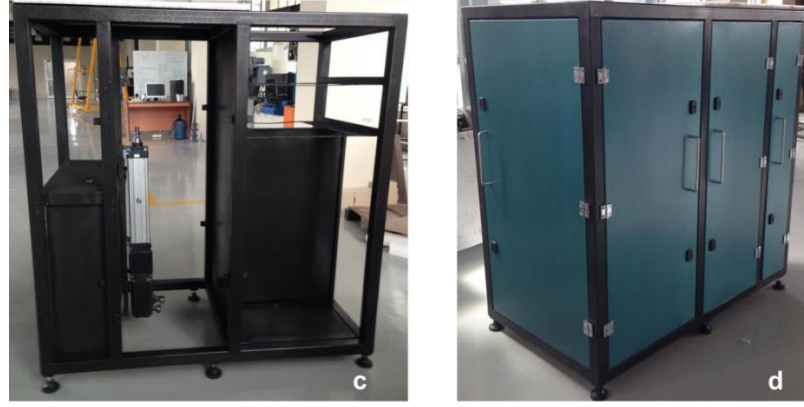
Şekil 5.18. Ana gövde imal edilmiş gerçek resmi a) izometrik bakış b) dimetrik bakış c) ana gövde önden bakış (lineer eyleyici monteli durum) d) en dış sac kapaklar kapatılmış durum
