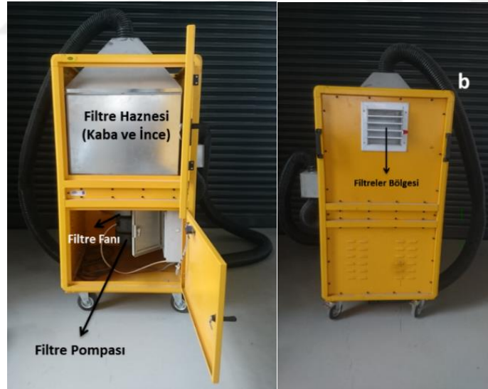
Şekil 5.39. Harici filtre cihazı a) fan ve pompa pozisyonu b) filtrelerin pozisyonu
