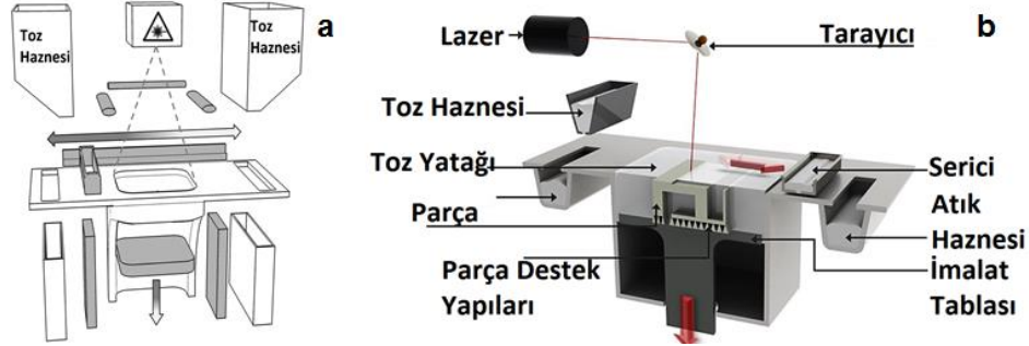
Şekil 2.2. Üstten toz besleme mekanizmaları a) Çift taraflı b) Tek taraflı [Baumers vd., 2011; Tilmann vd., 2017]
