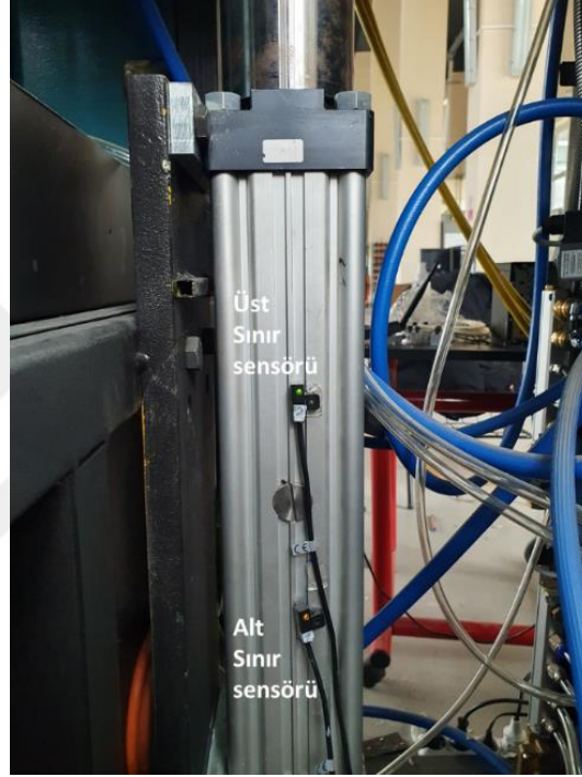
Şekil 5.22. İmalat tablasını tahrik eden z-motor gövdesine bağlı a) en üst sınır ve b) en alt sınır sensörleri
