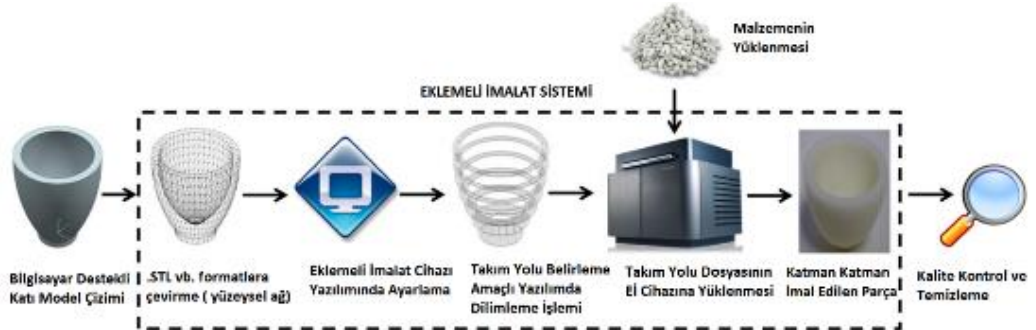
Şekil 1.1. Eklemeli imalat işlem basamakları [Sturm vd., 2017]
