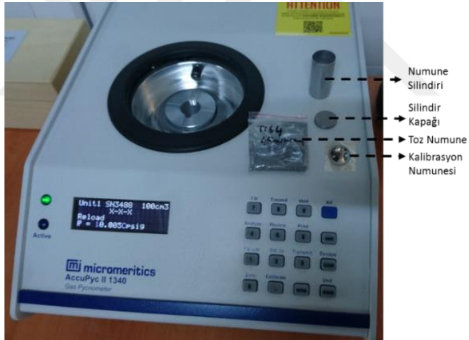
Şekil 3.11. Toz yoğunluk ölçüm cihazı ve kalibrasyon numunesi
