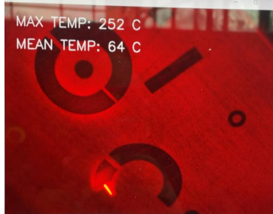
Şekil 6.20. Anlık sıcaklık ölçüm işlemi sırasında alınan görüntü (türbin çarklarından birinin ilgili kesiti lazer tarafından yakılmaktadır)
