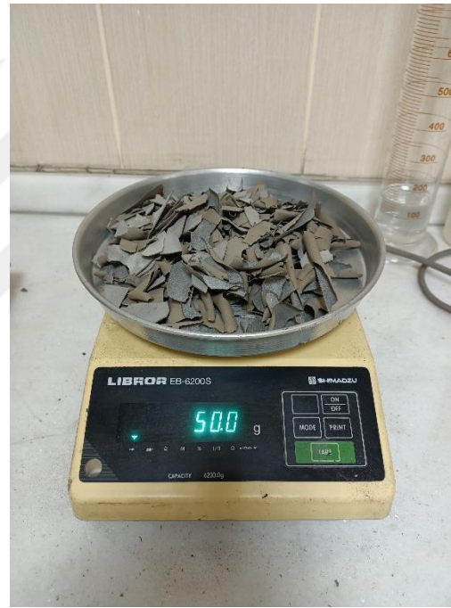
Şekil 4. 4. Hidrometre deneyinde kullanılacak numunenin etüvde kurutulması ve tartılması
