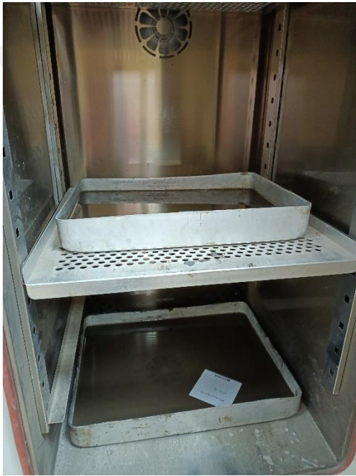
Şekil 4. 4. Hidrometre deneyinde kullanılacak numunenin etüvde kurutulması ve tartılması
