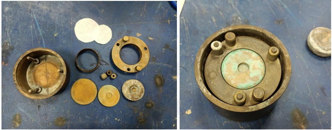
Şekil 5. 2. Konsolidasyon deney hücresi ve aparatları ve deneye hazır numune resmi
