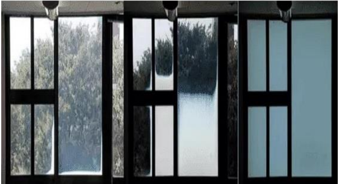
Şekil 2.144. Termokromik camın değişik durumlarda görünümü
