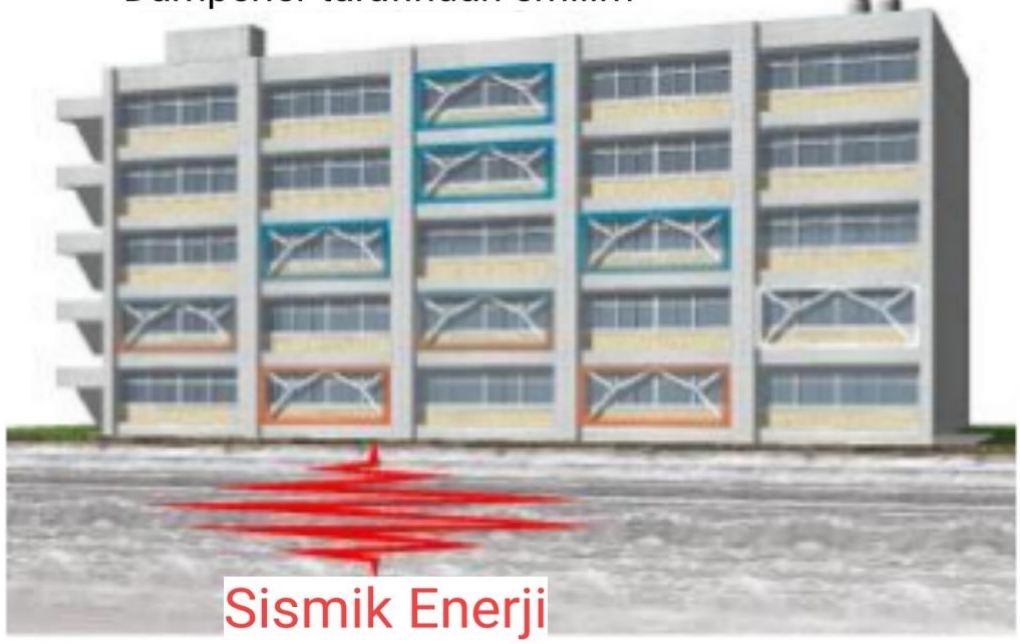
Şekil 2.71. Gelişmiş Titreşim Kontrol Çerçevesine Sahip Örnek Bina
