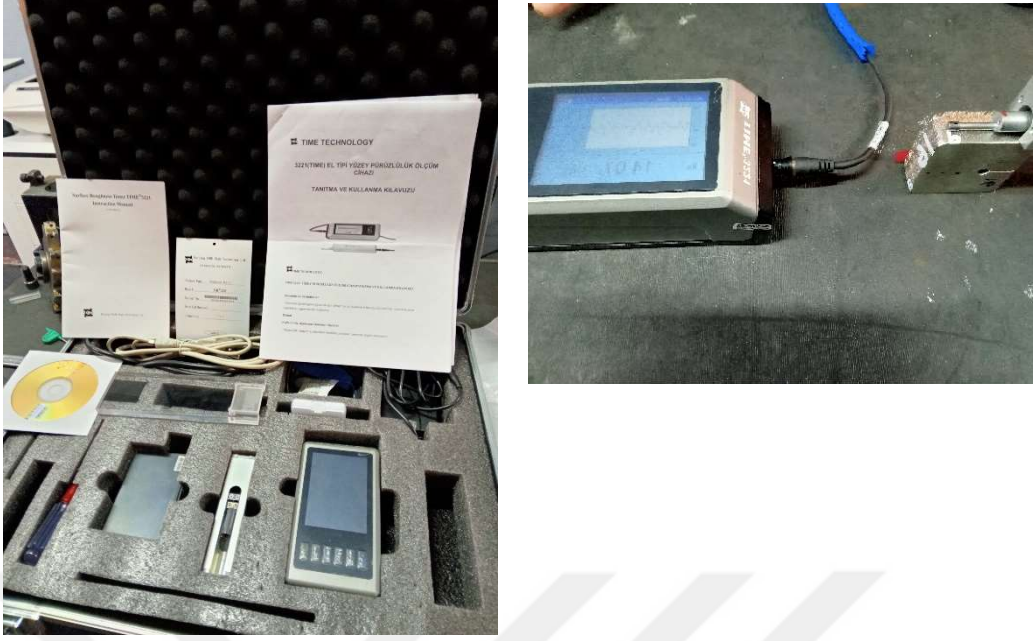
Şekil 3.6. Pürüzlülük ölçüm cihazı
