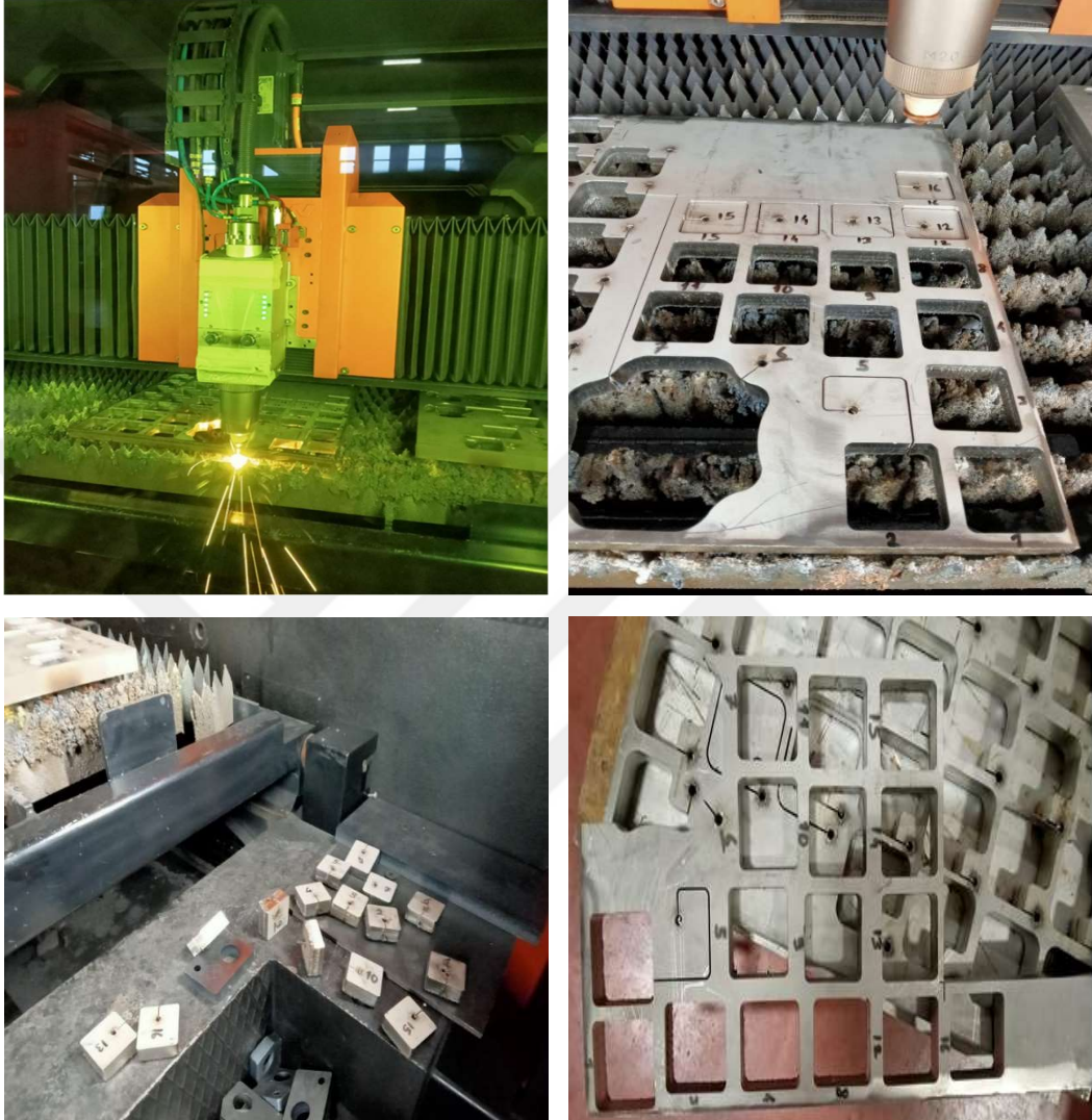
Şekil 3.5. Numune parçaların ana levhadan kesilerek çıkartılması
