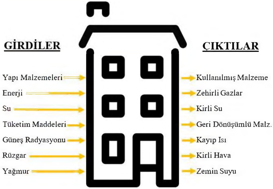
Şekil 3.5: Yapı endüstrisinde girdiler ve çıktılar (Sev, 2009)
