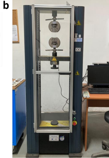
Şekil 6.13: Mikro Çekme Testi; a) Mikro Çekme Numunesi, b) Test Cihazı
