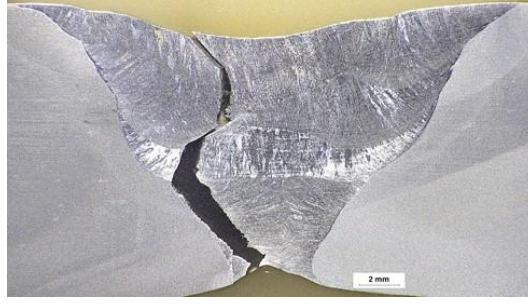
Şekil 7.11: Östenitik Kaynak Çekme Testi Sonrası Kırılma Yönü İncelemesi
