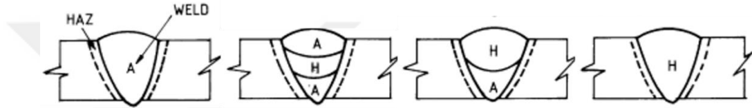
Şekil 5.1: Kullanılan Kaynak Kombinasyonlarının Şematik Görüntüsü; a) Östenitik, h) Sert Dolgu
