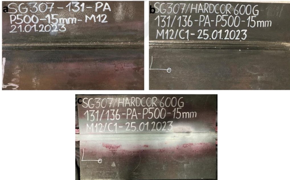
Şekil 7.1: Kaynaklı Plakaların Genel Görüntüsü ve Sıvı Penetrant Test Görüntüleri; a) Östenitik Kaynak Dikiş Görüntüsü, b) Sandviç Kaynak Dikiş Görüntüsü, c) Sandviç Kaynak Sıvı Penetrant Test Görüntüsü
