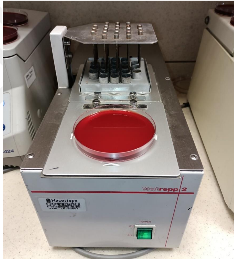
Şekil 3.1. Agar dilüsyon cihazı ile bakteri inokulumlarının plaklara inokülasyonu.
