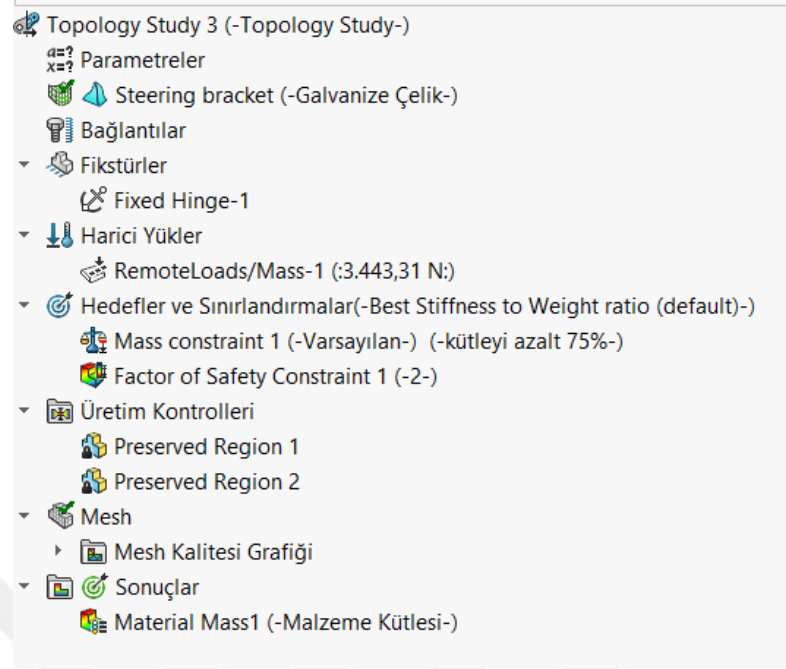
Şekil 3.30. Topoloji Optimizasyonu Tüm Sınır Koşullarının Verilmesi
