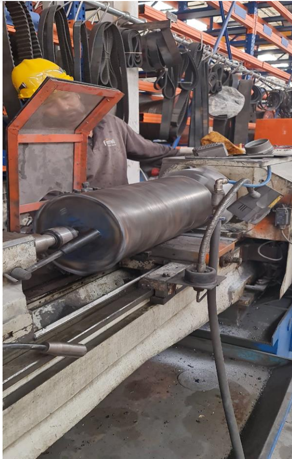
Şekil 3.14. Silindirik kaptaki rulman bilyesi ile öğütme denemesi
