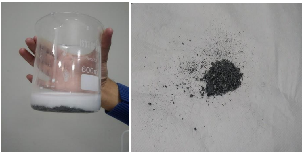
Şekil 3.9. Su-Atık sabun çözeltisi ve çözülmeyen metal parçacıklar
