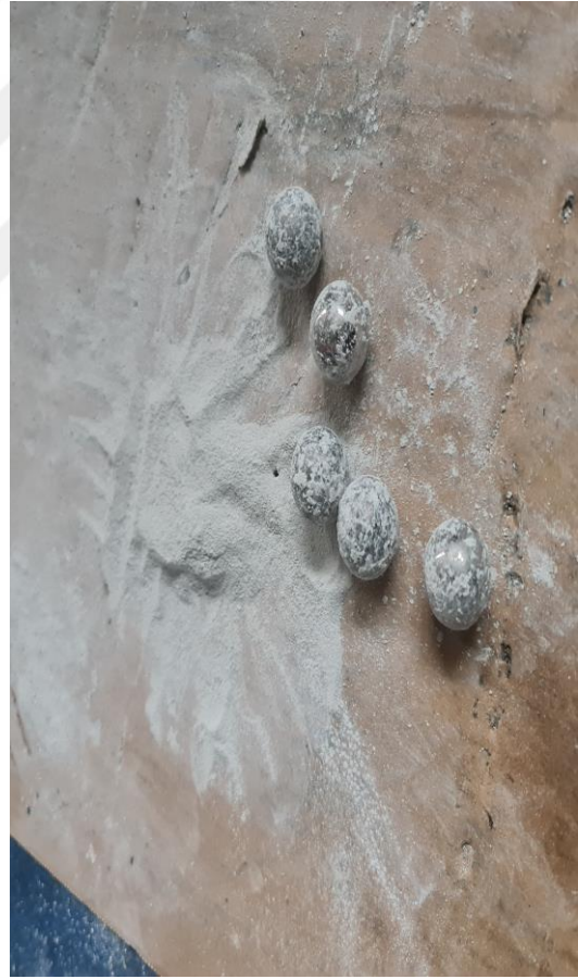
Şekil 3.14. Silindirik kaptaki rulman bilyesi ile öğütme denemesi
