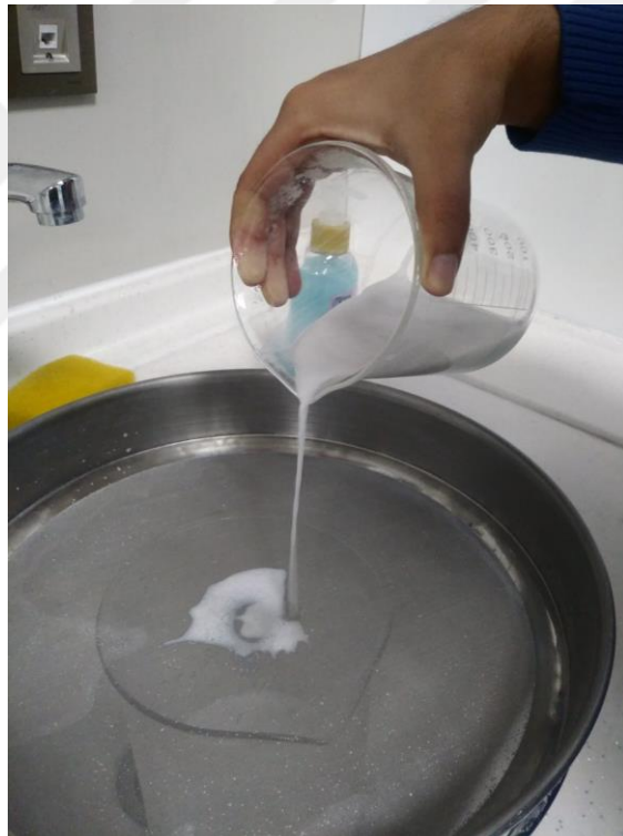
Şekil 3.10. Çözeltiyi 50 mesh elekten geçirme işlemi
