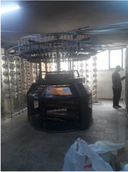
Resim 2.6. Örme işletmesi bünyesinde bulunan yuvarlak örme makinelerinden bir örnek (Arslan, 2018)
