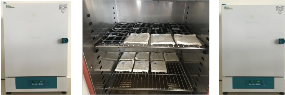
Resim 3.7. Etüv cihazı ve numunelerin etüve yerleştirilmesi (Arslan, 2022)
