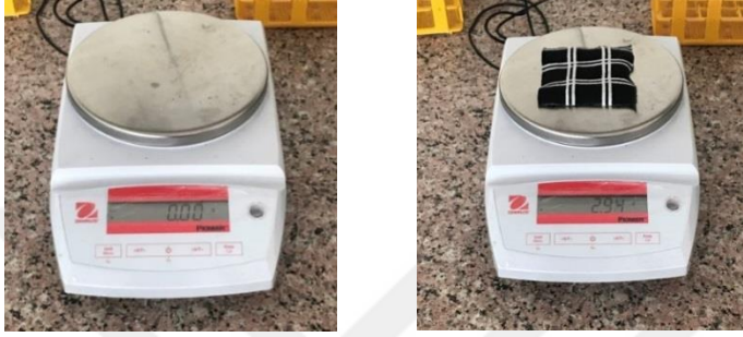
Resim 3.8. Numunelerin gramaj tayininde kullanılan hassas terazi (Arslan, 2022)
