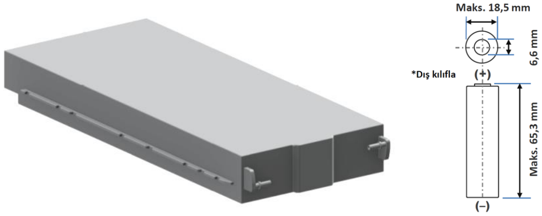
Şekil 4.11. Batarya paketinin model görünümü ve tipik bir 18650 tipi pile ait boyutlar
