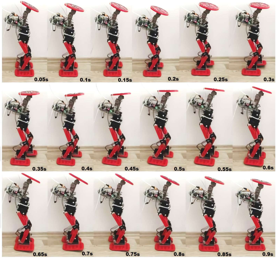
Şekil 3.26. İki ayaklı robotun ağır çekim adım hareketi.
