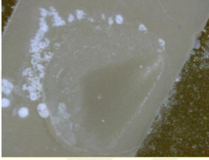
Şekil 4.8 Koheziv tipte kopmanın seramik yüzeyinde görüntüsü
