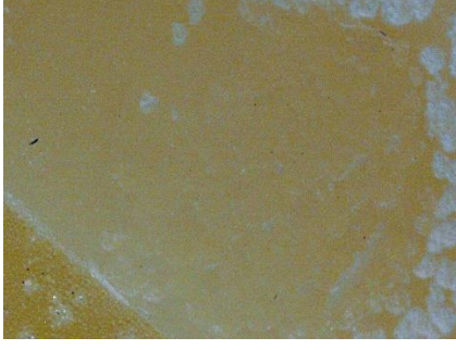
Şekil 4.7 Adeziv tipte kopmanın seramik yüzeyinde görüntüsü
