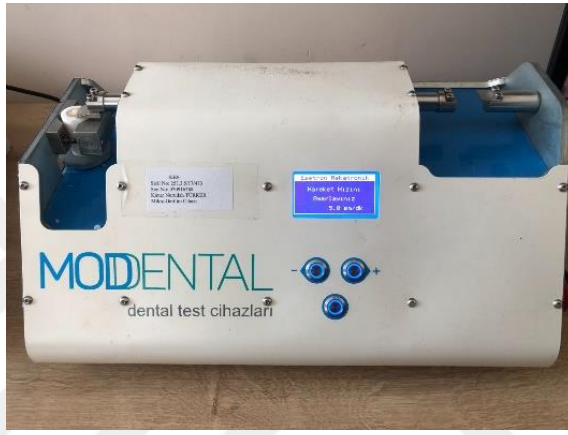
Şekil 3. 15 Esetron mikrogerilim test cihazı
