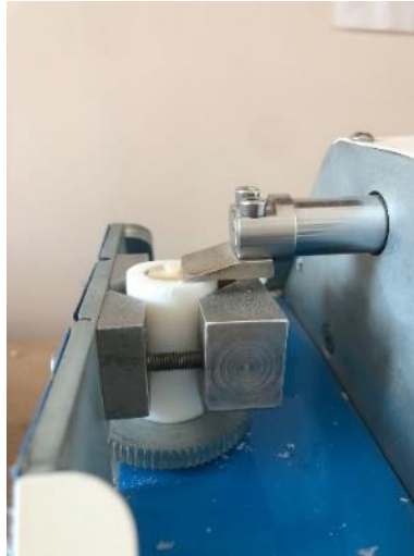
Şekil 3. 16 Makaslama baęlanma dayanımı testi uygulaması
