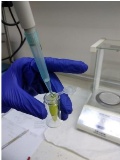
Şekil 3. 6 %9,5'luk HF asitin laboratuvar ortamında seyreltilmesi
