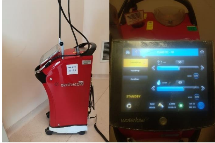
Şekil 3. 11 Waterlase lazer cihazı ve örneklerin pürüzlendirilmesinde kullanılan parametreler
