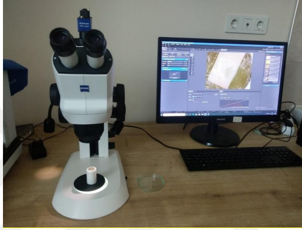
Şekil 3. 17 Kırılma tiplerinin belirlendiği stereomikroskop ve bilgisayar düzeneği
