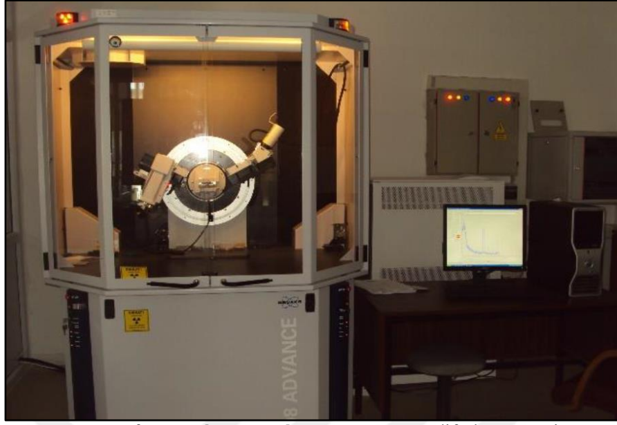
Fotoğraf 5.2 Bruker D8 Advance toz X-ışını difraktometresi
