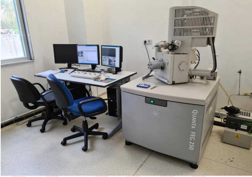
Şekil 2: FEI Quanta FEG 250 ESEM elektron mikroskobu.
