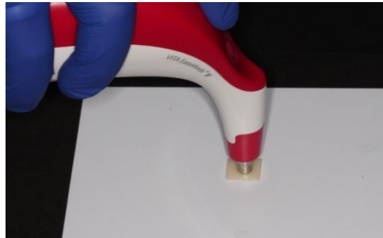
Şekil 2.18. Örneklerin beyaz arka fonda renk ve translusensi değerlerinin ölçülmesi.
