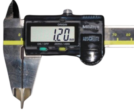
Şekil 2.11. Örneklerin final kalınlıklarının dijital kumpas ile ölçülmesi.
