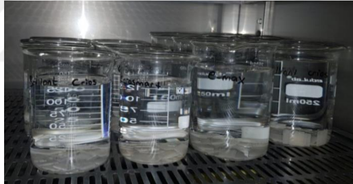
Şekil 2.14. Örneklerin standardizasyonunu sağlamak için distile suda bekletilmesi
