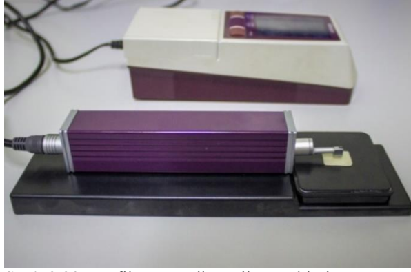
Şekil 2.20. Profilometre cihazı ile örneklerin yüzey pürüzlülüğünün ölçülmesi.
