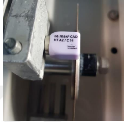
Şekil 2.3. IPS e.max CAD blokların Isomet cihazında kesilmesi.
