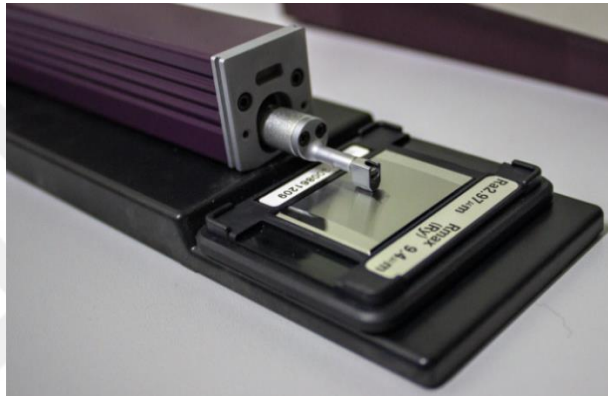
Şekil 2.21. Profilometre cihazının kalibrasyon plakası ile kalibre edilmesi.
