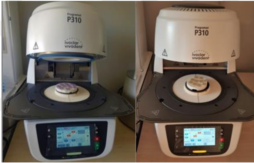
Şekil 2.5. IPS e.max CAD örneklerinin Programat P310 fırınında kristalizasyon işleminin gerçekleştirilmesi.
