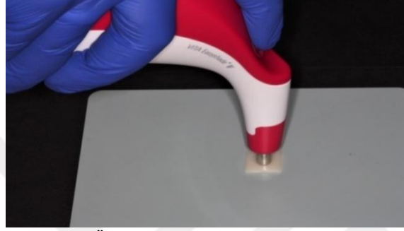
Şekil 2.16. Örneklerin gri arka planda renk ve translusensi değerlerinin ölçülmesi.
