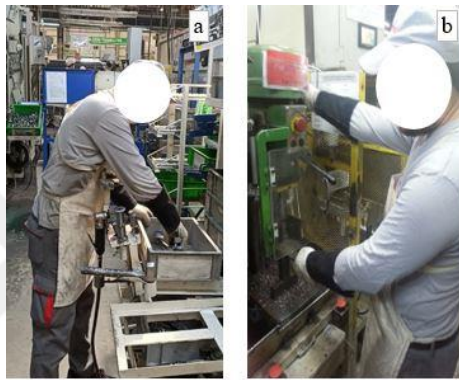
Şekil 6.8. Pedal kaynak / montaj hattı. (a) kutu itme, (b) havşa açma
