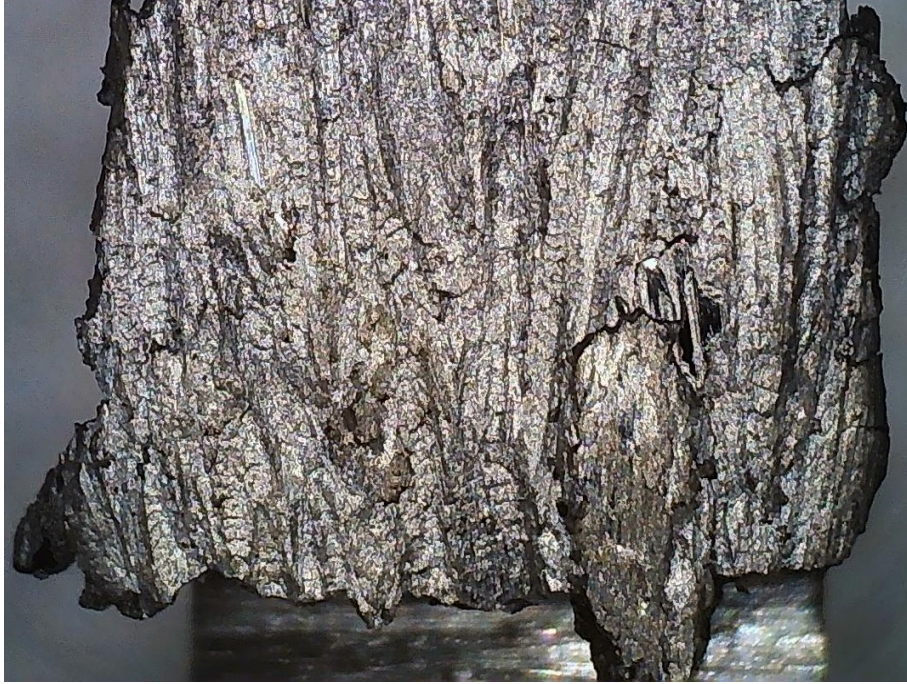
Resim 4.3 Etial 177 (N3) numunesinin kuru srtnme sonrası mikroskopik grnts.
