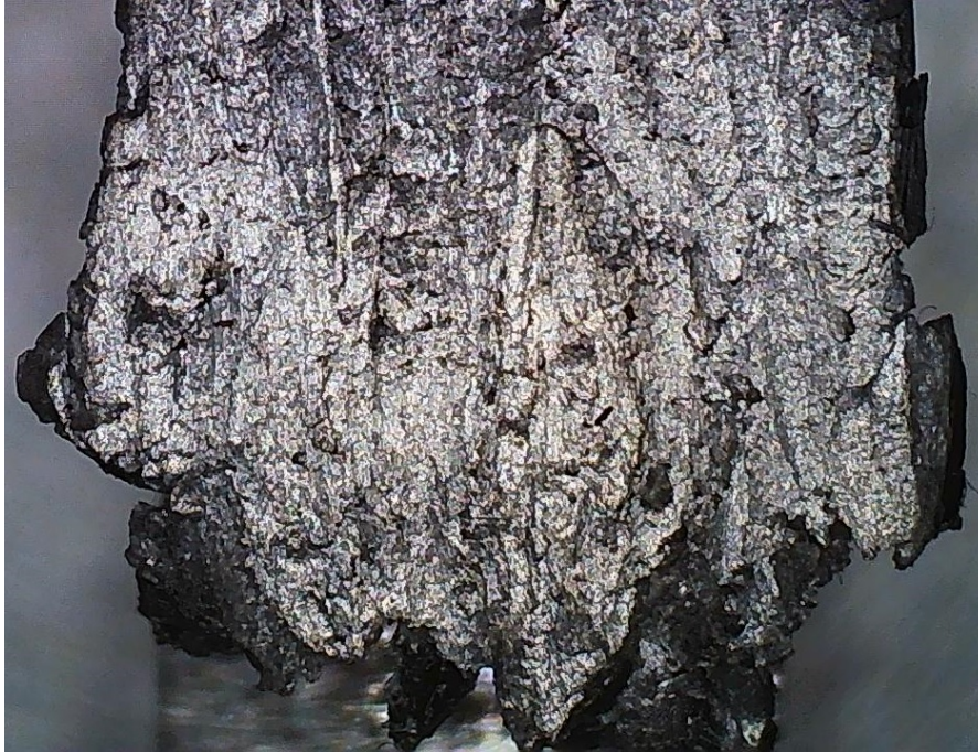
Resim 4.1 Etial 140 (N1) numunesinin kuru sürtünme sonrası mikroskopik görüntüsü.
