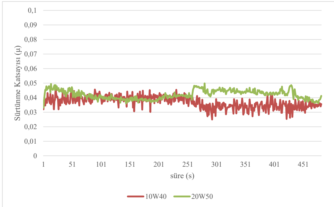
Şekil 4.12 N1 numunesinin 800 devir/dakika’da farklı yağlarla sürtünme katsayısı değişimi.
