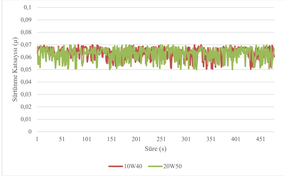
Şekil 4.17 N3 numunesinin 1200 devir/dakika'da farklı yağlarla sürtünme katsayısı değişimi.
