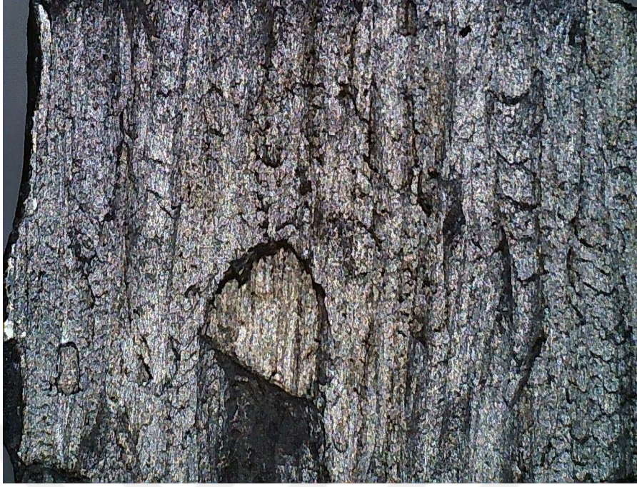
Resim 4.2 Etial 170 (N2) numunesinin kuru srtnme sonrası mikroskopik grnts.
