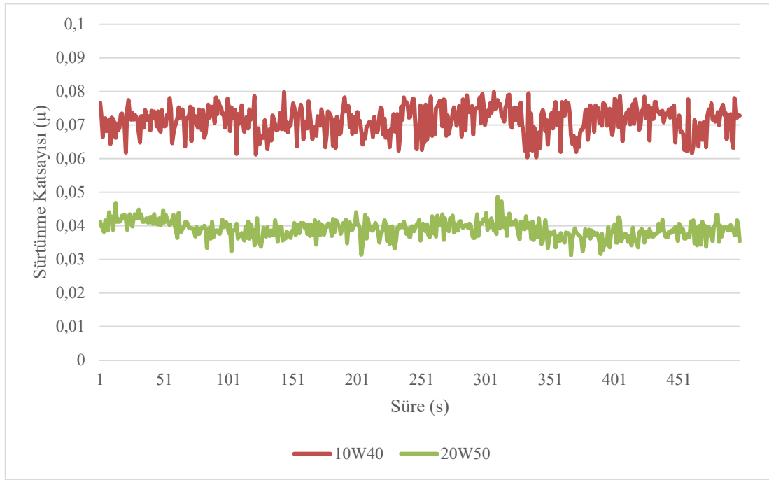
Şekil 4.13 N2 numunesinin 800 devir/dakika'da farklı yağlarla sürtünme katsayısı değişimi.
