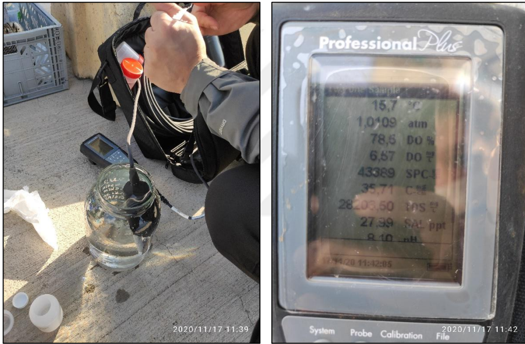
Şekil 27. Sahada anlık olarak fiziksel parametrelerin ölçülmesi
