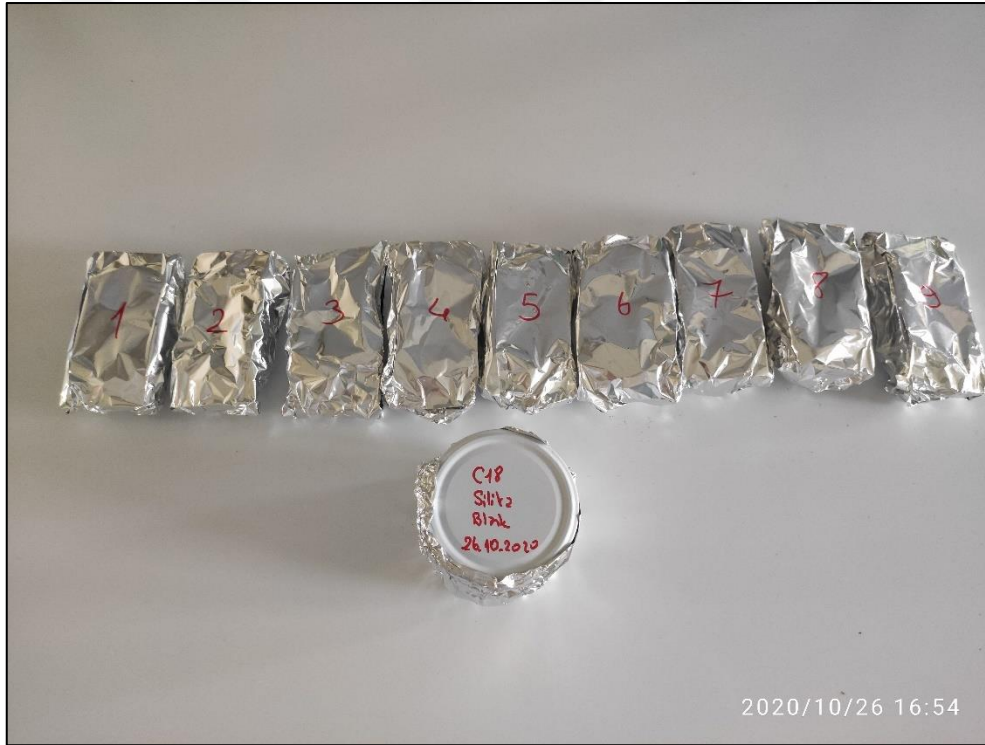
Şekil 25. Saha çalışmaları için hazırlanan yerli pasif örnekleyciler.
