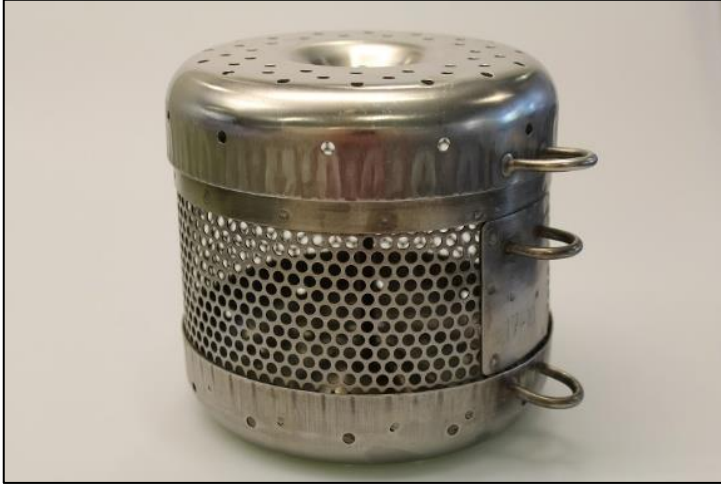
Şekil 12. Pasif örnekleyici kafesi (çelik)
