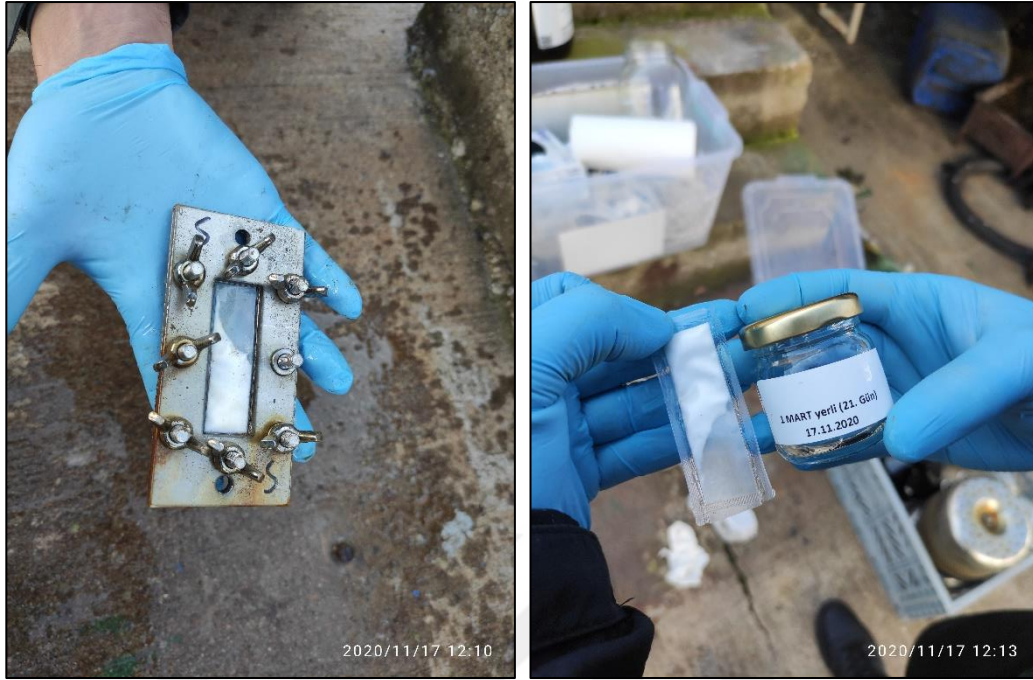
Şekil 33. Sahadan toplanan örnekleyicilerin temizlenmesi ve muhafaza kaplarına aktarılması.
