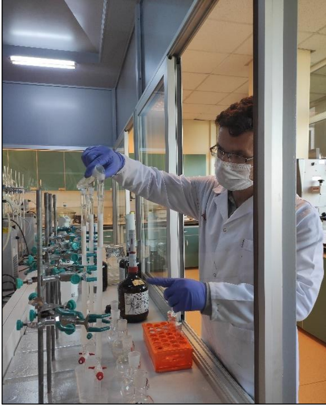
Şekil 34. Anlık su örneklerinde PAH analizi temizleme prosedürü (kolon aşaması).
