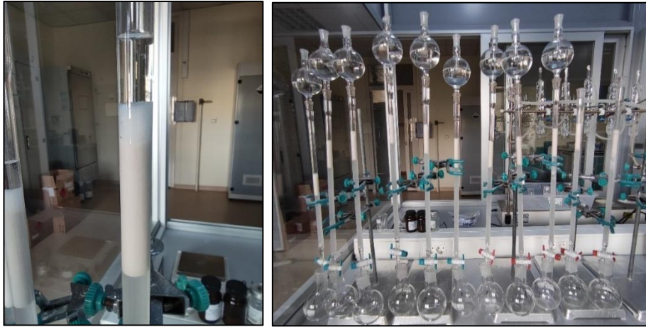
Şekil 38. Pasif örnekleyicilerde temizleme prosedürü (kolon aşaması).
