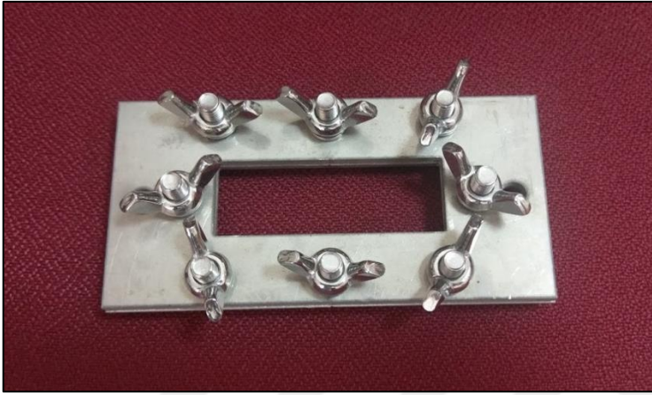
Şekil 11. Yerli pasif örnekleyicide kullanılacak yerli üretim gövde (housing)
