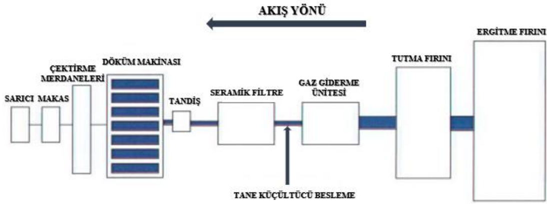
Şekil 3.8 : İkiz merdane sürekli döküm hattı akış şeması [1].
