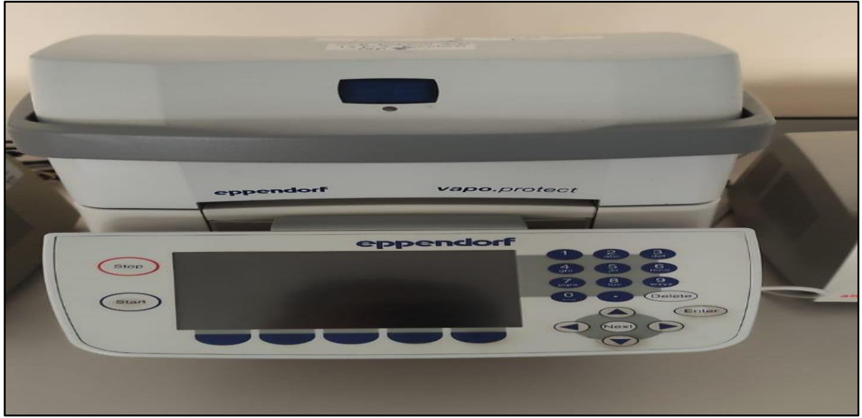
Şekil 5. Candida DNA'larının çoğaltılmasında kullanılan PCR cihazı
