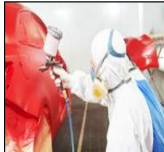
Şekil 33. Araçların kaportaları korozyondan boyanarak korunur
