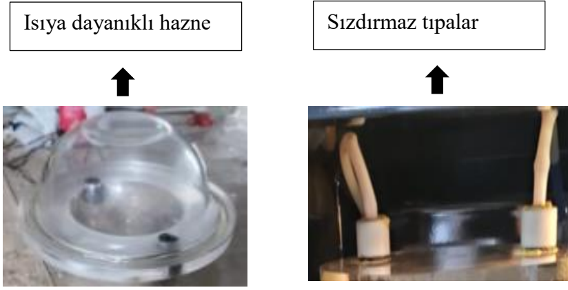
Şekil 2.4. Çalışmada kullanılan mikrodalga plazma düzeneği/sistemi (vakumlu pompa, gaz tüpü, kontrol cihazı, sistem iç yapısı, tabla, voltaj ayar düğmesi, ısıya dayanıklı hazne, sızdırmaz tıplar)
