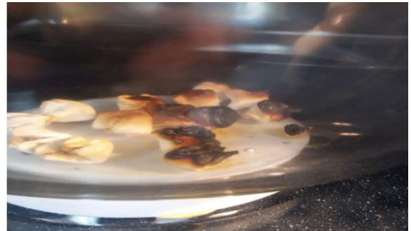
Şekil 2.5. Plazma deşarjında fazla argon gazı kullanımının mantı üzerindeki yakıcı etkisi
