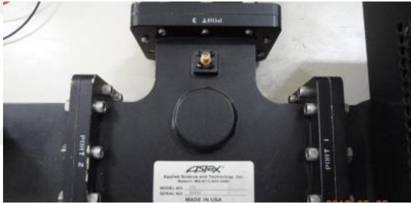
Şekil 1.4. Astex CS2 model 3 portlu sirkülatör (Bozduman, 2012:32)
