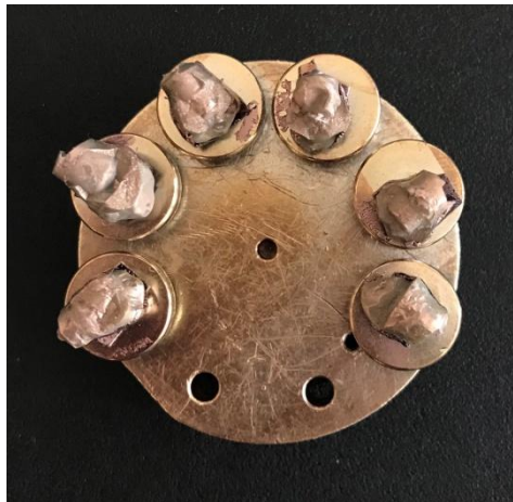
Resim 39: Numunelerin SEM analizinden önce altınla kaplanmış görüntüsü
