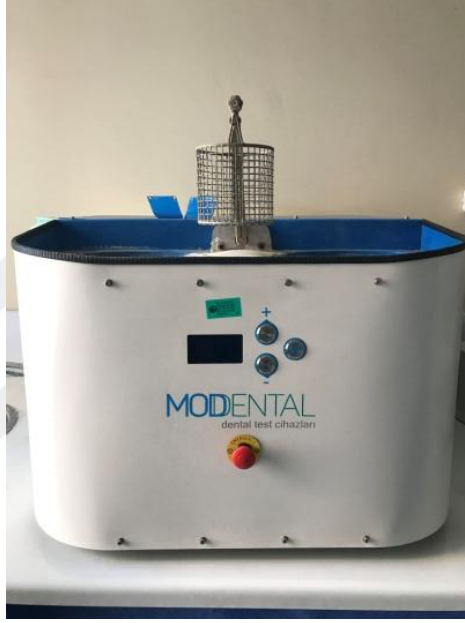
Resim 33: Çalışma örneklerine yaşlandırma işleminin uygulandığı cihazın görüntüsü
