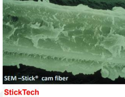
Resim 2: Akrilik kaideden ayrılmayan cam fiberin SEM görüntüsü
