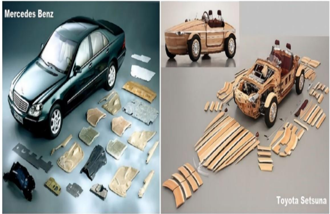
Şekil 1.6 : Biyokompozitten üretilmiş otomobil parçaları (Lotfi ve diğ, 2021).
