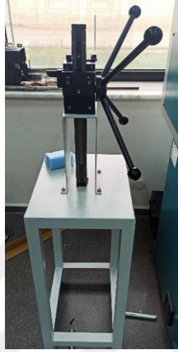
Şekil 9.40 Çentik darbe testi için V-çentik açma cihazı
