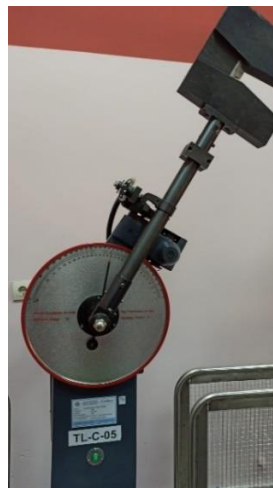
Şekil 9.41 Charpy-V çentik darbe testi cihazı.
