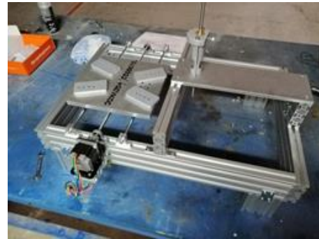
Şekil 9.13 Step motor ve parça tutucular.
