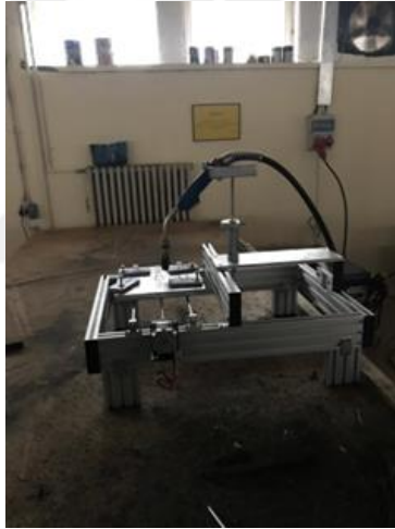
Şekil 9.17 MAG kaynağında kullanılan kaynak mekanizması.
