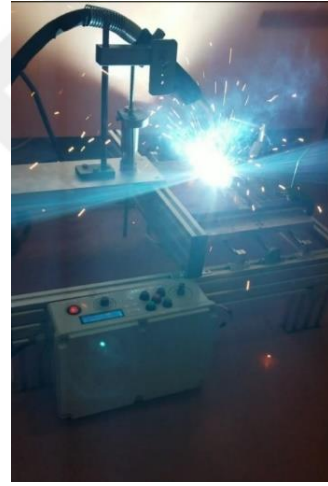
Şekil 9.17 MAG kaynağında kullanılan kaynak mekanizması.
