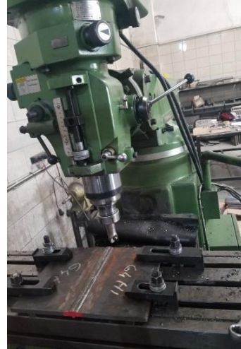
Şekil 9.28 Freze tezgahında talaş kaldırma.
