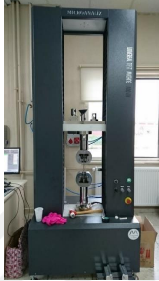
Şekil 9.44 Çekme test cihazı.
