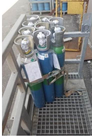
Şekil 9.1 MAG kaynağında kullanılan karışım gaz tüpleri.
