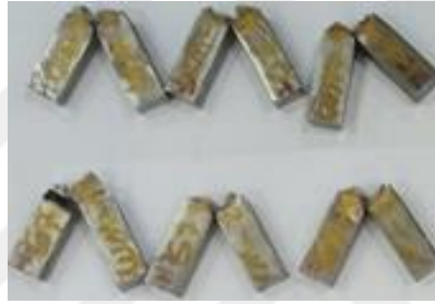
Şekil 10.38 Charpy-V çentik darbe testi sonrası numuneler.
