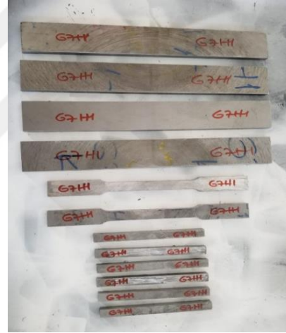
Şekil 9.30 CNC’de işlenen eğme, çekme, çentik darbe test numuneleri.
