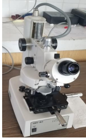
Şekil 9.37 Sertlik ölçüm cihazı.
