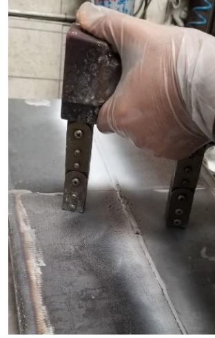
Şekil 9.25 Manyetik parçacık test.
