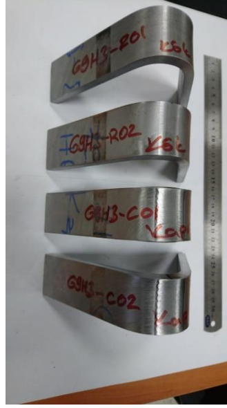
Şekil 10.29 Eğme testi sonrası numunelerin görünümü.
