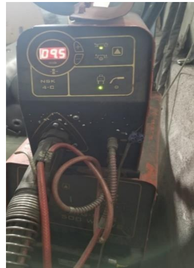
Şekil 9.2 MAG kaynağında kullanılan kaynak makinesi.
