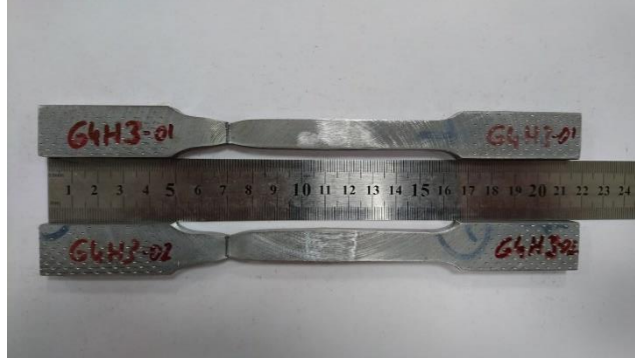
Şekil 10.20 Çekme testi gerçekleştirilmiş numune.
