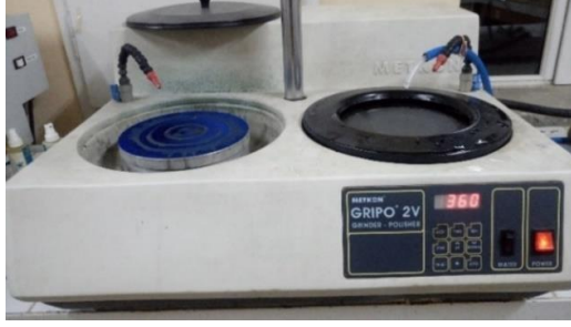
Şekil 9.31 Zımparalama ve parlatma cihazı. Şekil 9.32 Makro test numunesi.
