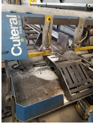
Şekil 9.27 Şerit testerede kesim.
