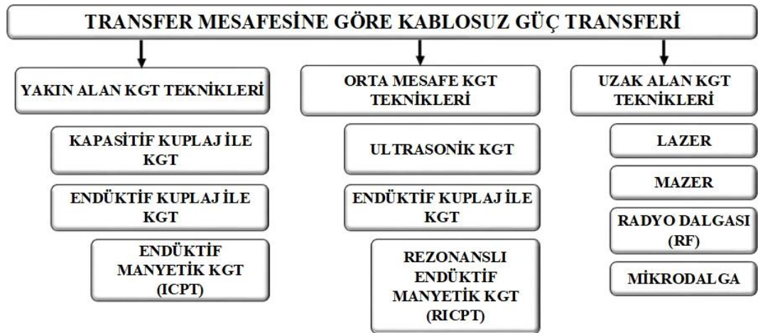
Şekil 2.8 : Transfer mesafesine göre KGT'nin sınıflandırılması.
