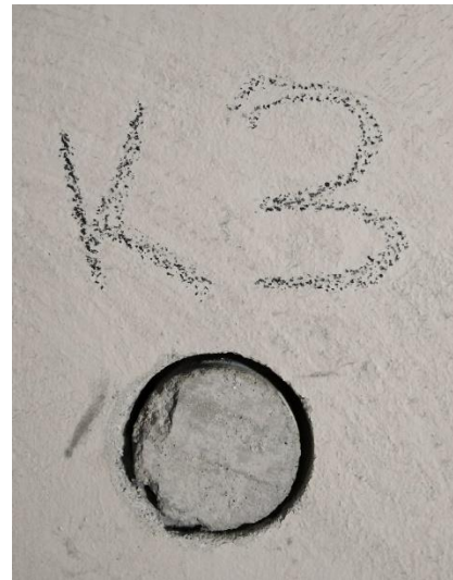
Şekil 3.8. Misakı Milli ilkokulunun kolonlarından karot alma işleminden görünüm.
