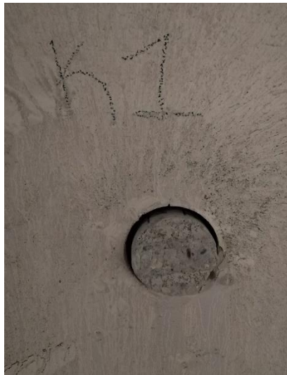
Şekil 3.8. Misakı Milli ilkokulunun kolonlarından karot alma işleminden görünüm.
