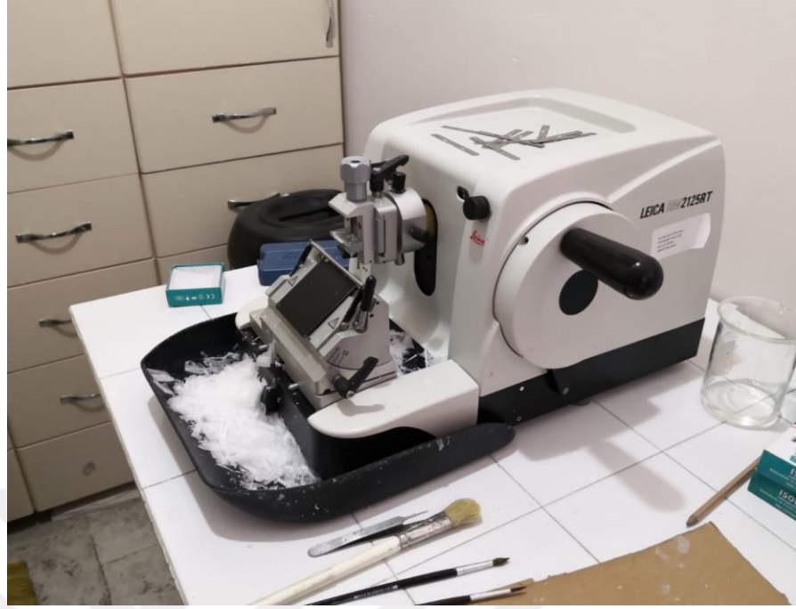
Şekil 2.19. Histolojik kesitlerin alınması sırasında kullanılan mikrotom cihazı (Leica RM 2125 RT, Germany)
