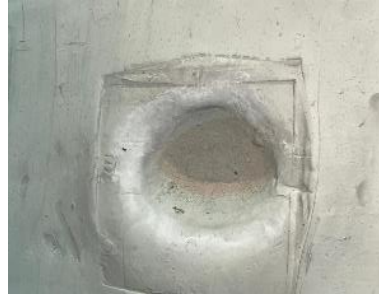
Fotoğraf 3.11. Top düşürme testinden sonra oluşan oyuk
