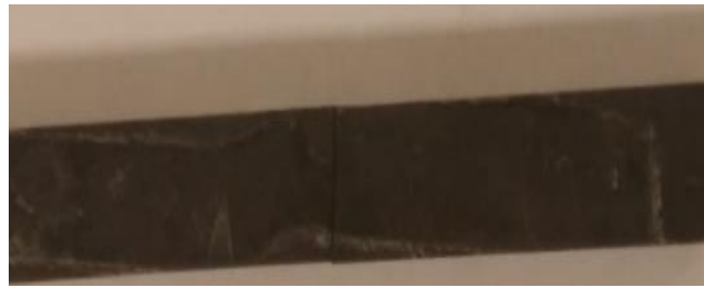
Fotoğraf 3.7. Tek yüzey tek kat grafen transferi gerçekleşmiş SiC çubuk
