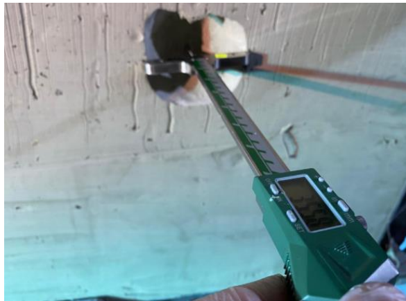
Fotoğraf 4.1. Roma plastilina kili penetrasyon değerlerinin ölçümü
