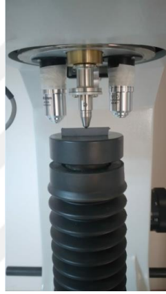
Şekil 3.21. Vickers sertlik ölçümünün yapılması
