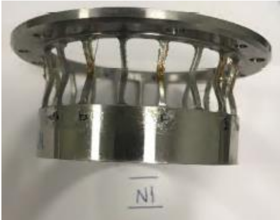
Şekil 6.12 : Birinci sincap kafes test numunesi hasar durumunun üstten görünüşü.
