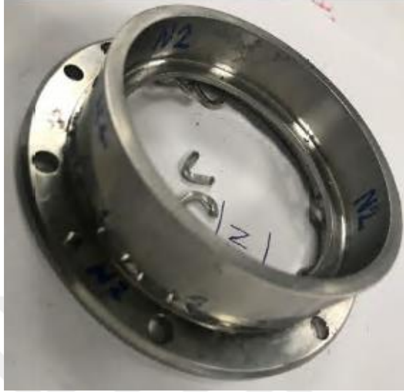
Şekil 6.15: ikinci sincap kafes test numunesi hasar durumunun çapraz görünüşü.
