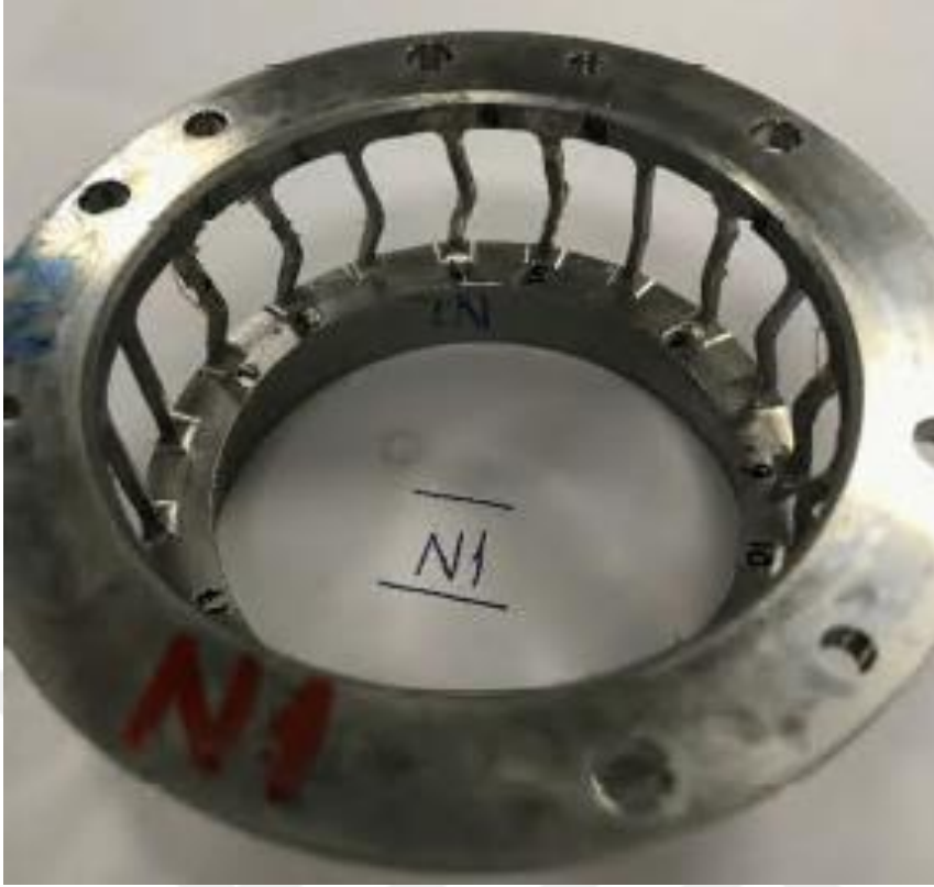
Şekil 6.13: Birinci sincap kafes test numunesi hasar durumunun önden görünüşü.
