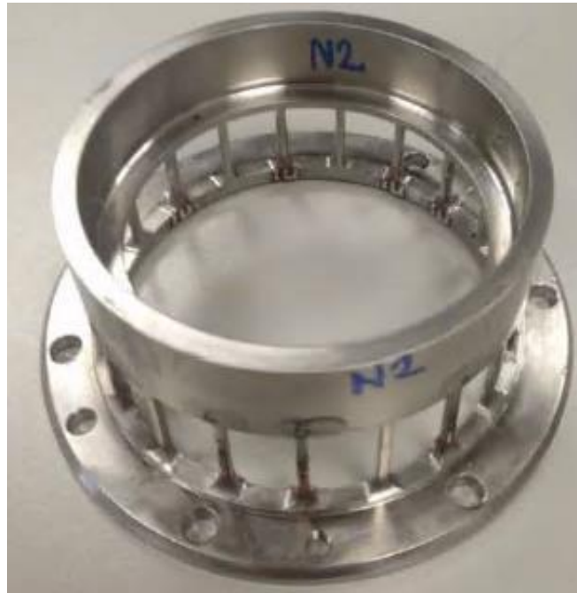
Şekil 6.5 : İkinci sincap kafes test numunesi.
