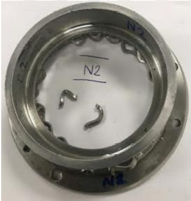
Şekil 6.14: İkinci sincap kafes test numunesi hasar durumunun arkadan görünüşü.
