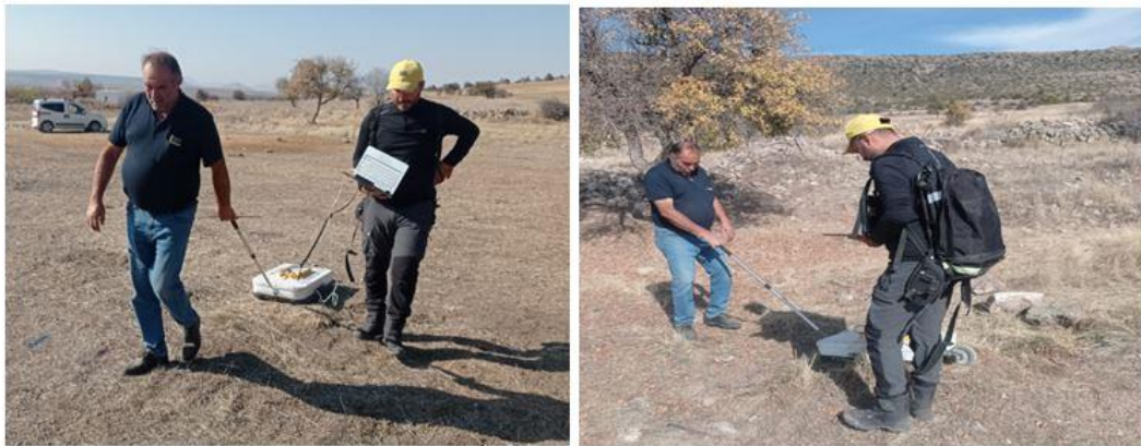
Şekil 4.3. GPR ölçüm cihazı ve sahadan görüntüler
