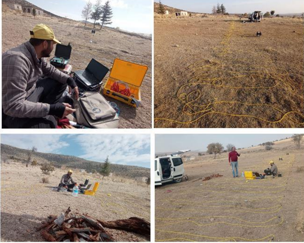
Şekil 4.2. ERT ölçüm cihazı ve sahadan görüntüler
