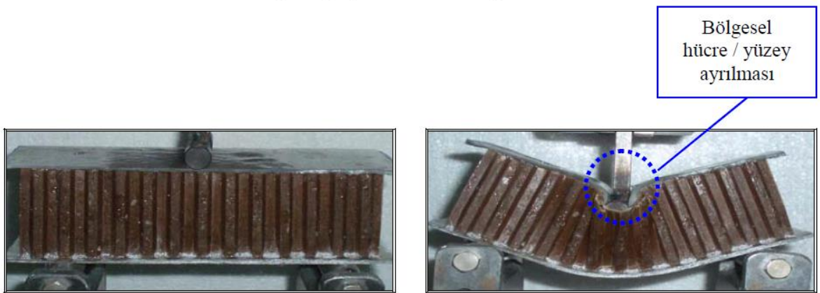
Şekil 1.3 Çekirdek boyutu 5 mm olan kağıt bal petekli sandviç levhanın eğilme yükü altında hasar görüntüsü (Solmaz ve diğ., 2010)
