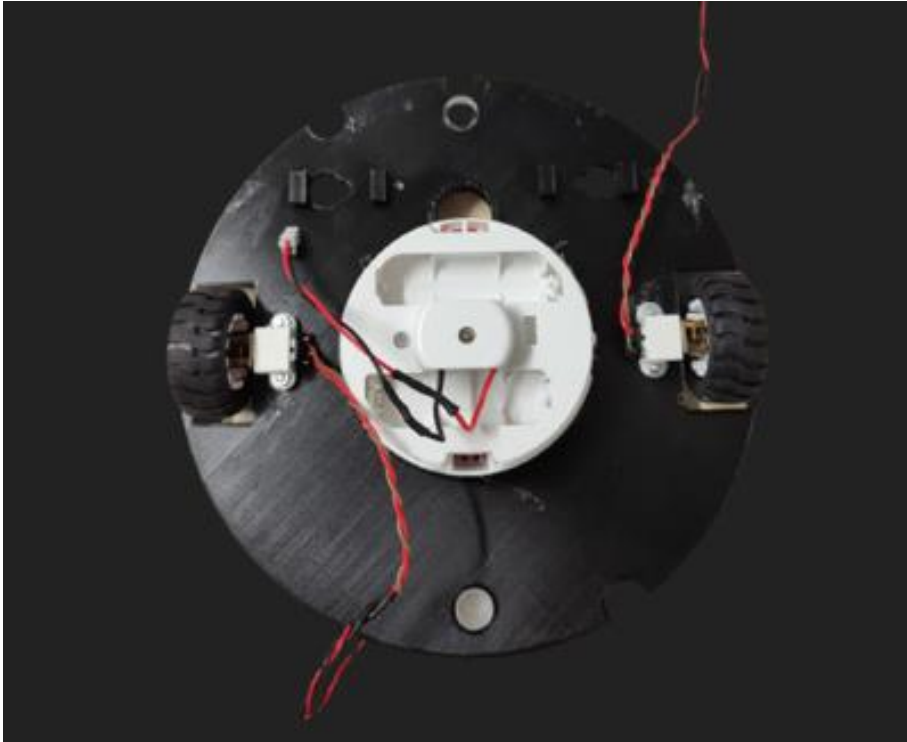
Şekil 4.1 Tekerlekler ve Vakum Aparatının Montajı
