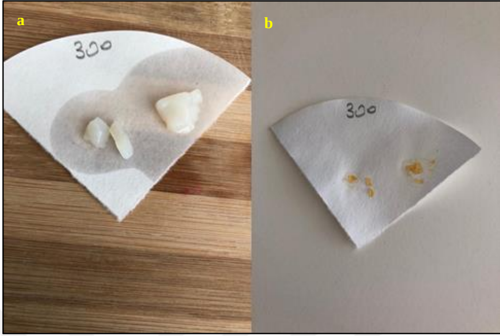
Şekil 6.6: Yapısında 0,03 g MBAAm bulunan hidrojinin ıslak (a) ve kuru (b) haldeki görselleri.
