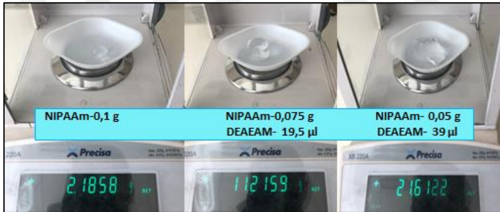
Şekil 6.13: Tablo 6.4’te hazırlanan hidrojellerin 4 gün suda bekletildikten sonraki ağırlıkları ve görselleri.
