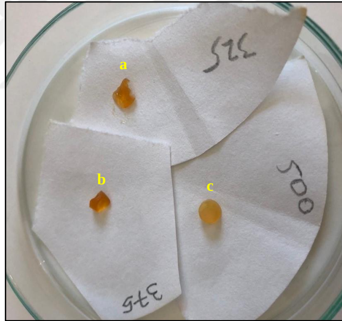
Şekil 6.8: 0,0325 (a), 0,0375 (b) ve 0,05 (c) g MBAAm içeren kuru hidrojeller.
