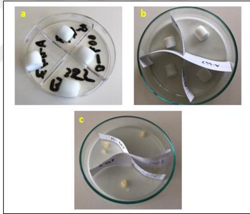
Şekil 6.11: Tablo 6.3'e göre sentezlenen hidrojellerin oda koşullarına alındığı zamanki hali (a), hidrojellerin oda koşullarında bir süre durduktan sonraki hali (b), hidrojellerin etüvden sonra kurutulmuş hali (c).
