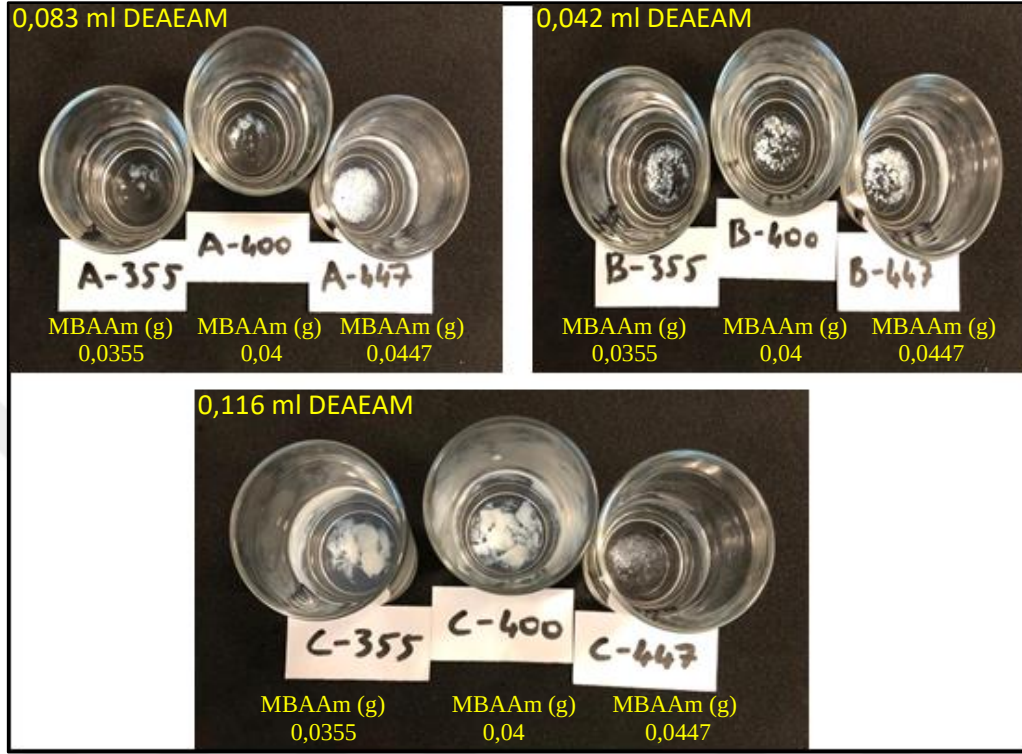
Şekil 6.12: Tablo 6.3'e göre sentezlenen hidrojellerin kurutulduktan sonra saf suya atıldıklarındaki durumu (C-355 ve C-400 numuneleri hariç).
