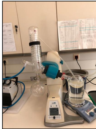
Şekil 5.4: Kloroformun döner buharlaştırıcı cihazı ile solüsyondan ayrılması.
