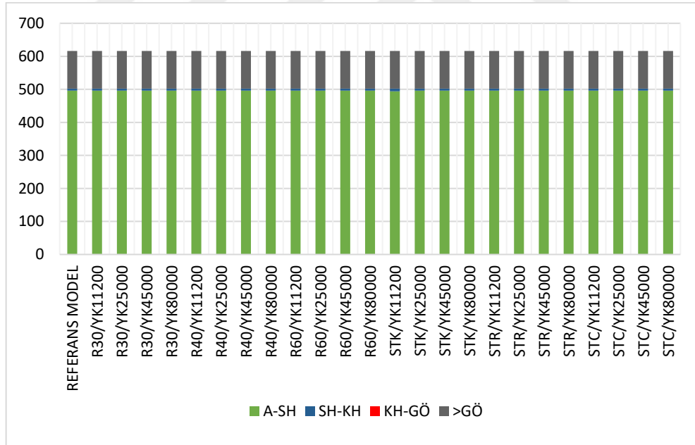
Şekil 5.24. 4 Katlı betonarme çerçeve bina modellerine ait x yönü plastik mafsalları hasar durumu dağılımı
