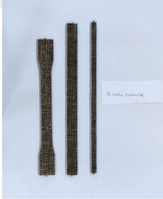
Şekil 3.36. 5 no'lu kompozite ait çekme, eğme, kısa kiriş ve tokluk testlerine ait temsili numune görüntüleri
