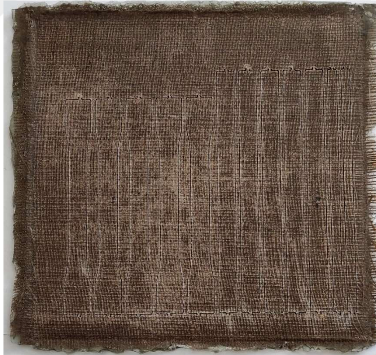
Şekil 3.24. 4 no'lu kompozitten su jetiyle test numunelerinin çıkartılışı
