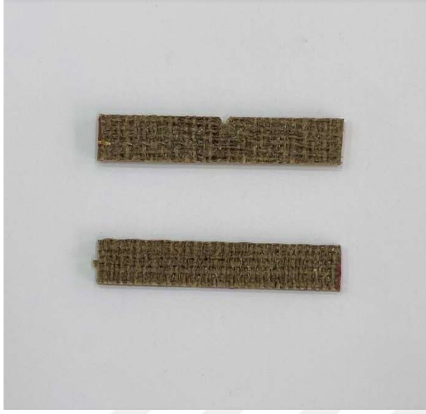
Şekil 3.45. Test öncesi çentikli ve çentiksiz numunelere ait temsili görüntü
