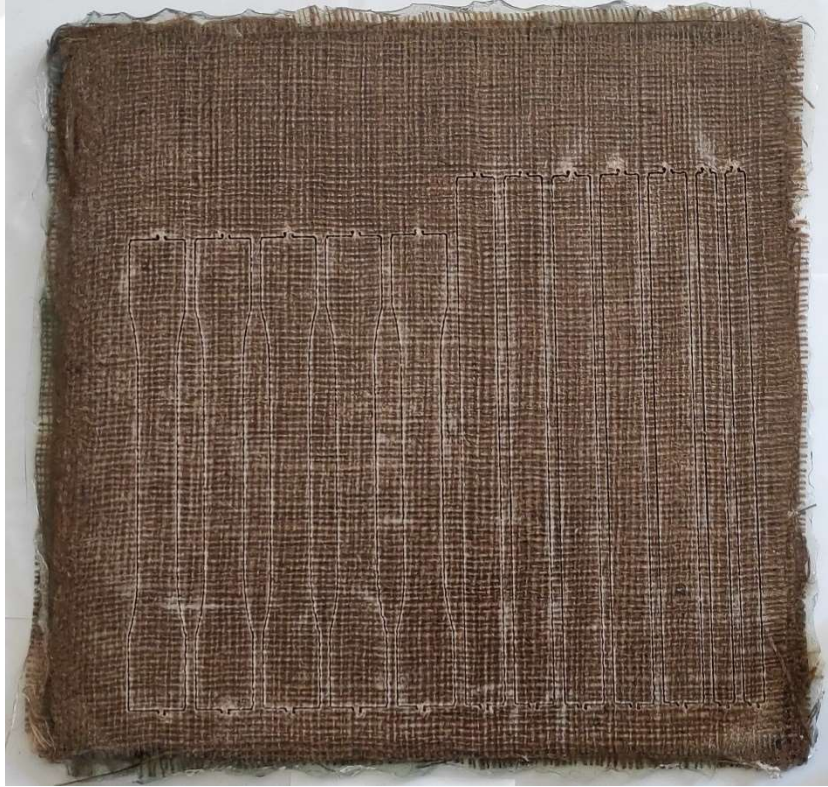
Şekil 3.26. 6 no'lu kompozitten su jetiyle test numunelerinin çıkartılışı
