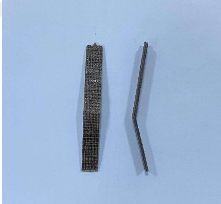
Şekil 4.27. 10 no'lu numunenin eğme testi sonrası görüntüsü
