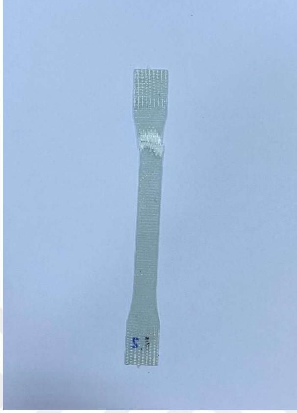
Şekil 4.4. 1 no'lu numunenin çekme testi sonrası görüntüsü
