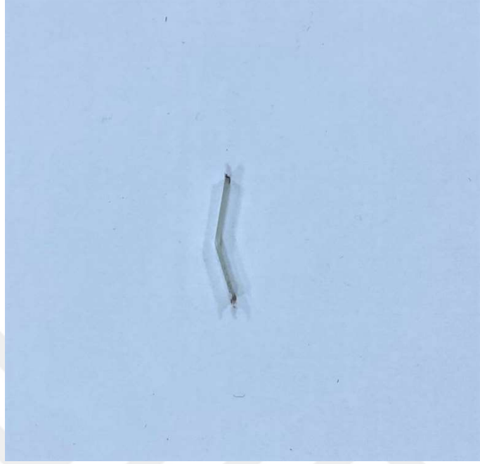
Şekil 4.54. 1 no'lu numunenin short beam testi sonrası görüntüsü
