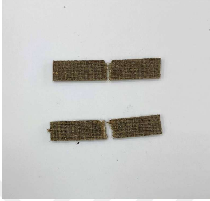
Şekil 4.39. 9 no'lu numunenin charpy testi sonrası görüntüsü
