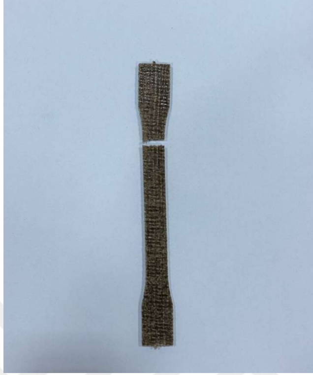
Şekil 4.8. 5 no'lu numunenin çekme testi sonrası görüntüsü
