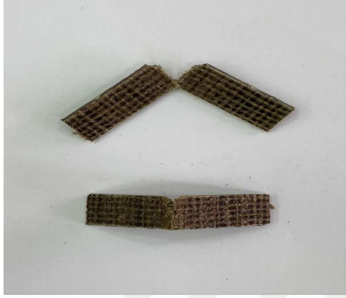
Şekil 4.41. 11 no'lu numunenin charpy testi sonrası görüntüsü
