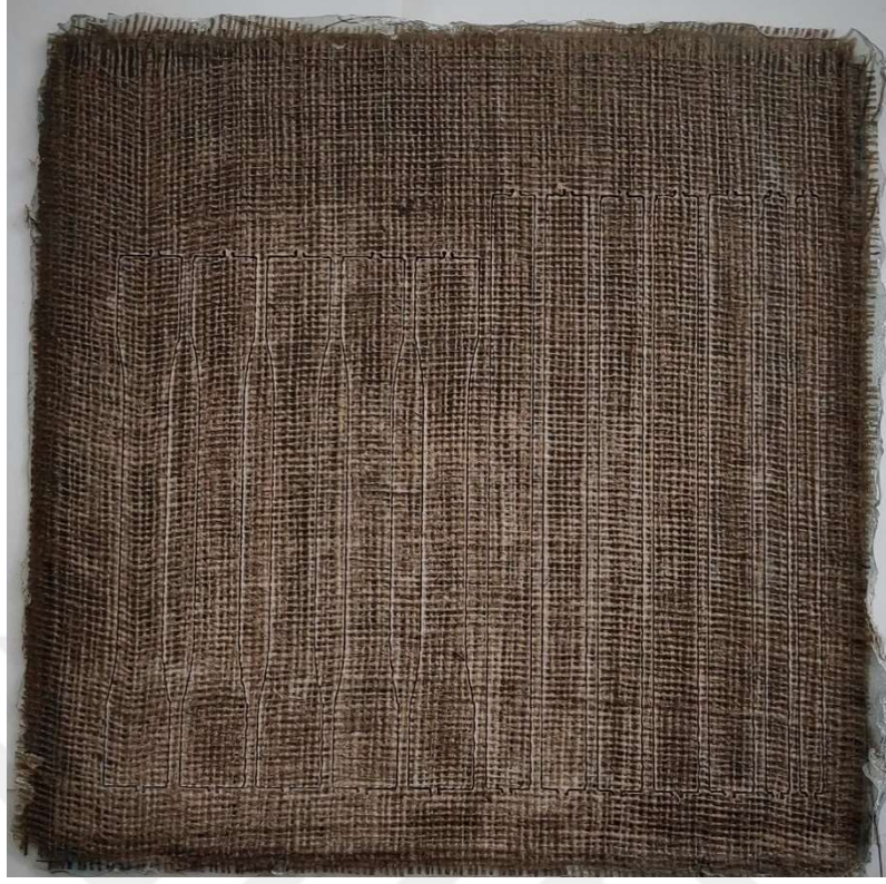
Şekil 3.27. 7 no'lu kompozitten su jetiyle test numunelerinin çıkartılışı
