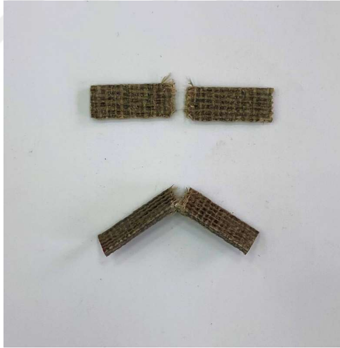
Şekil 4.40. 10 no'lu numunenin charpy testi sonrası görüntüsü
