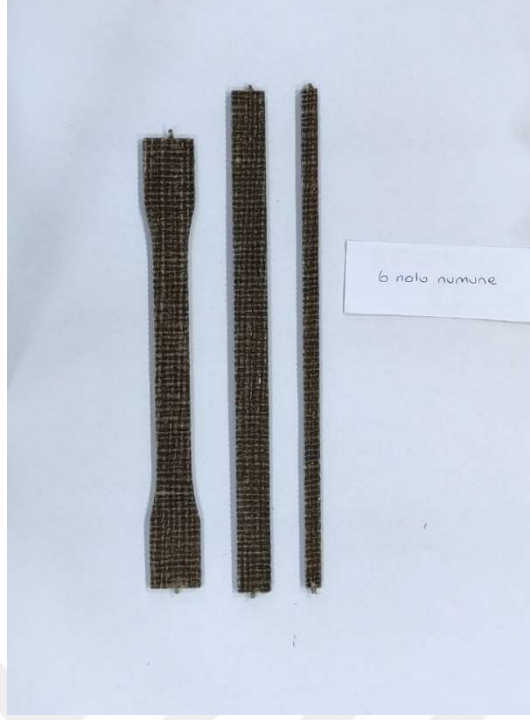
Şekil 3.37. 6 no'lu kompozite ait çekme, eğme, kısa kiriş ve tokluk testlerine ait temsili numune görüntüleri
