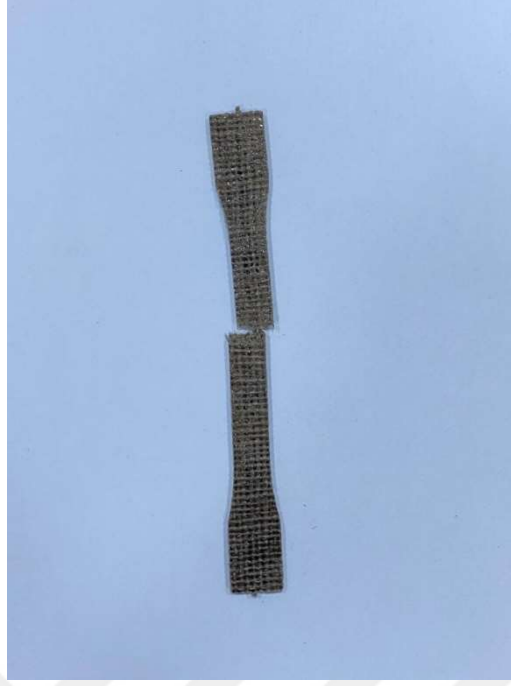
Şekil 4.10. 7 no'lu numunenin çekme testi sonrası görüntüsü
