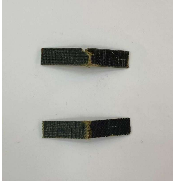
Şekil 4.32. 2 no'lu numunenin charpy testi sonrası görüntüsü
