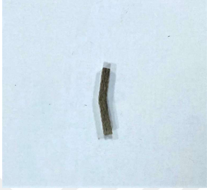
Şekil 4.58. 5 no'lu numunenin short beam testi sonrası görüntüsü
