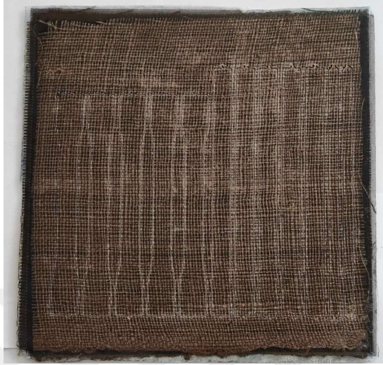
Şekil 3.31. 11 no'lu kompozitten su jetiyle test numunelerinin çıkartılışı
