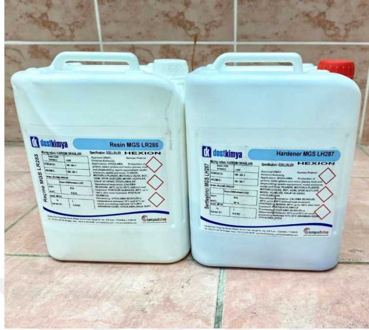
Şekil 3.9. Kompozit üretiminde kullanılan Epoksi (LR285) ve Sertleştirici (LH287)
