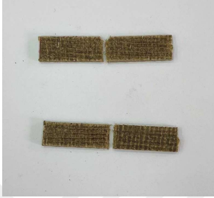
Şekil 4.35. 5 no'lu numunenin charpy testi sonrası görüntüsü
