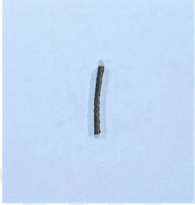
Şekil 4.64. 11 no'lu numunenin short beam testi sonrası görüntüsü
