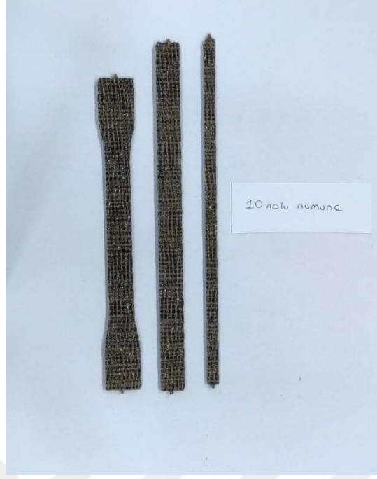
Şekil 3.41. 10 no'lu kompozite ait çekme, eğme, kısa kiriş ve tokluk testlerine ait temsili numune görüntüleri
