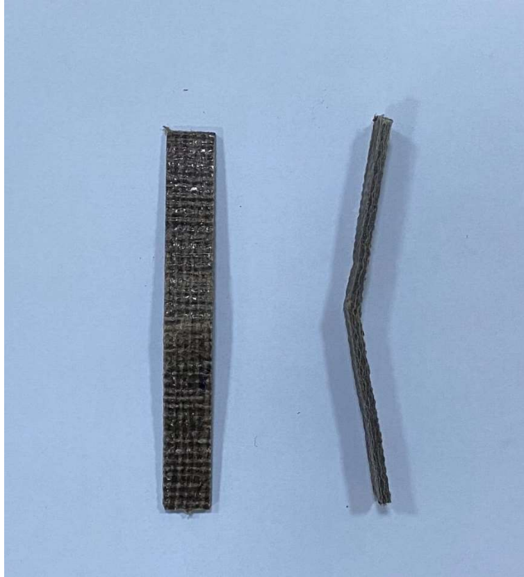
Şekil 4.25. 8 no'lu numunenin eğme testi sonrası görüntüsü
