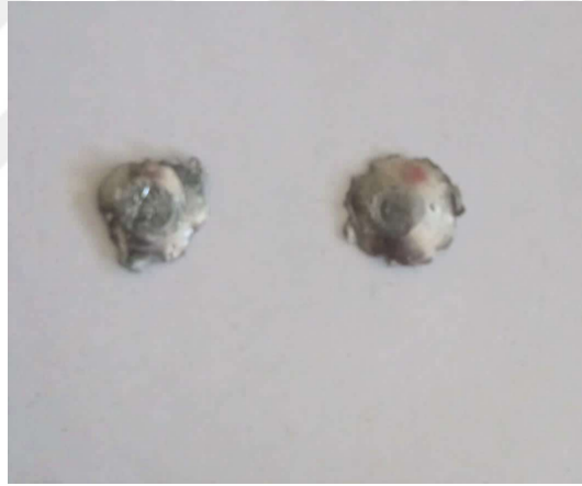
Şekil 4.69. 11 no'lu numune+2 adet Ck75 içerikli kompozite çarpan mermi görüntüsü
