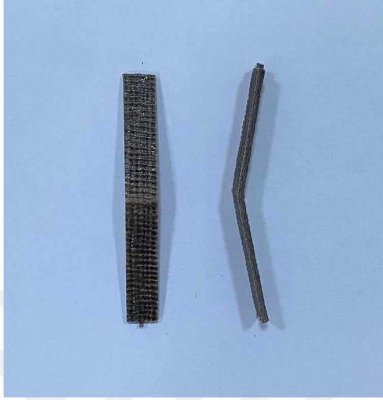
Şekil 4.24. 7 no'lu numunenin eğme testi sonrası görüntüsü
