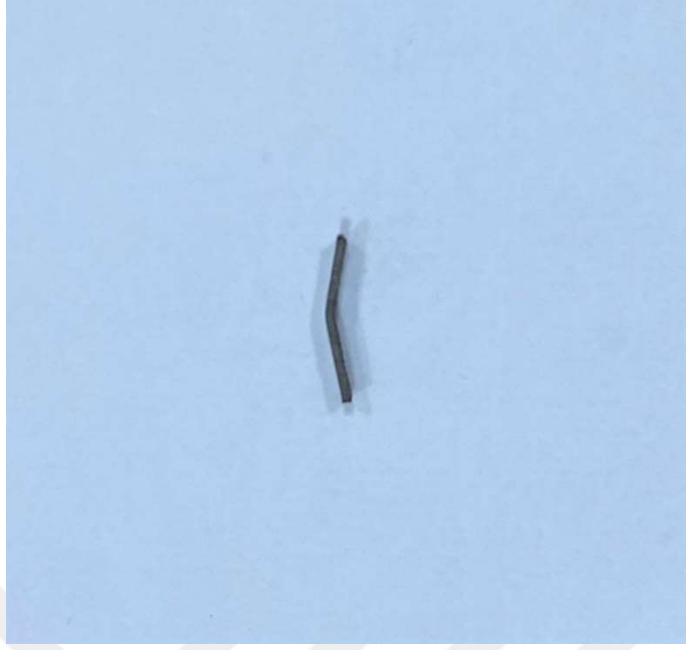
Şekil 4.56. 3 no'lu numunenin short beam testi sonrası görüntüsü
