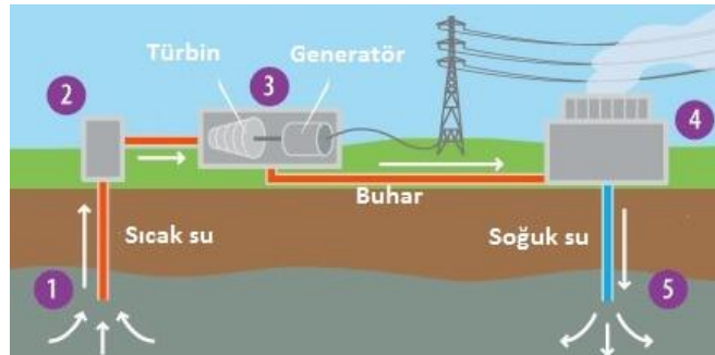
Şekil 2.4 Jeotermal santrallerinden elektrik üretimi şematik gösterimi [16].
